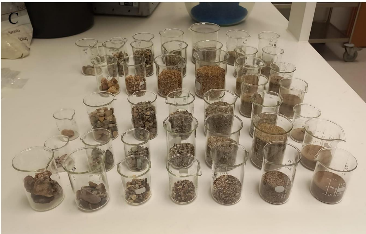
Sl. 3.17. Uzorci s terena (A), mokro sito (B), prosijani uzorci (C)
