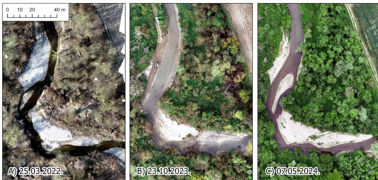
Sl. 4.22. Snimka geomorfološkog stanja istraživanog meandra prije (A), u vrijeme hidrotehničkih radova u koritu (B) i šest mjeseci kasnije (C)
