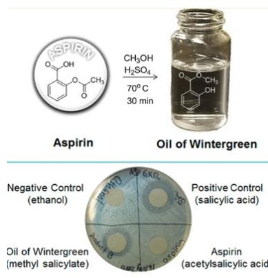
Slika 3.3. Prikaz pokusa sinteze ulja zimzelena (metil salicilata) iz aspirina te testiranja antibakterijskih svojstava pomoću testa inhibicije zone.<sup>33</sup>
