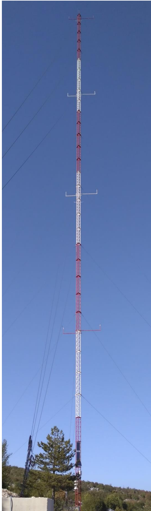
Slika 4: Toranj u zaleđu Rijeke s postavljenim mjernim uređajima. Mjerenje je provedeno od 1. siječnja 2012. do 29. veljače 2012. godine. Anemometri se nalaze na desnoj, a vjetrulje na lijevoj strani tornja.
