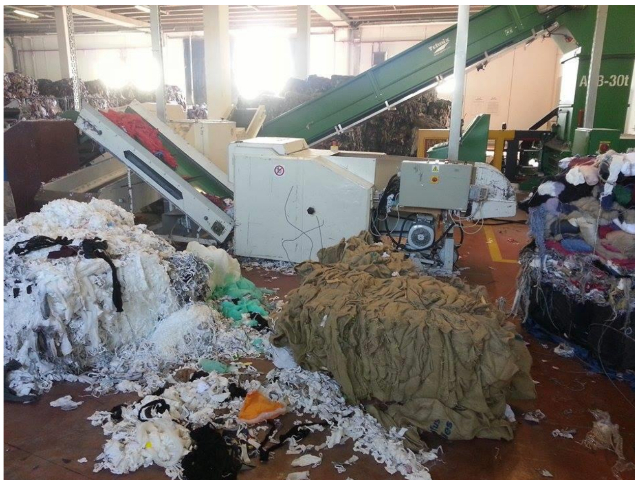
Slika 5. Hala i strojevi gdje se usitnjava i miješa tehnički i odjevni tekstil
