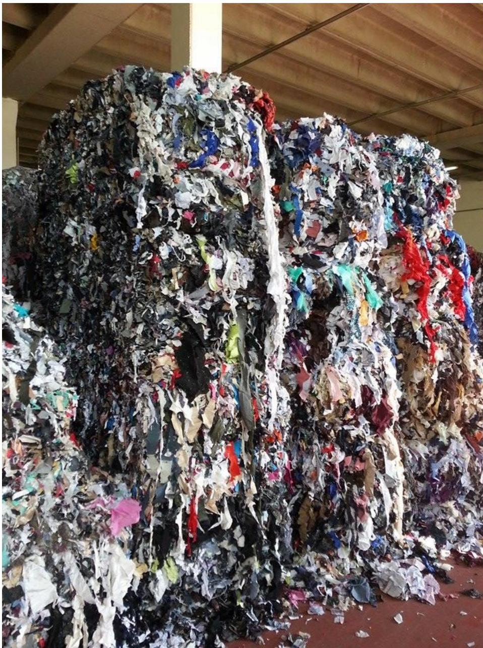
Slika 7. Poluproizvod dobiven nakon miješanja ustinjenih dijelova odjevnih predmeta sa tehničkim tekstilom.
