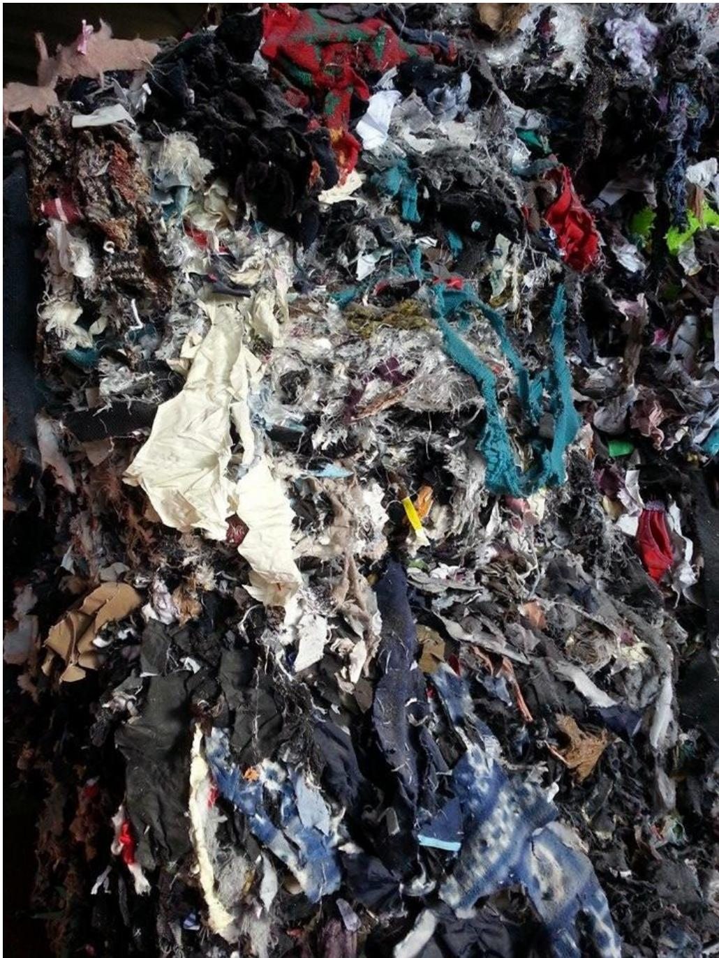
Slika 8. Poluproizvod nastao mješanjem tehničkog tekstila sa usitnjениm odjevnim predmetima.
