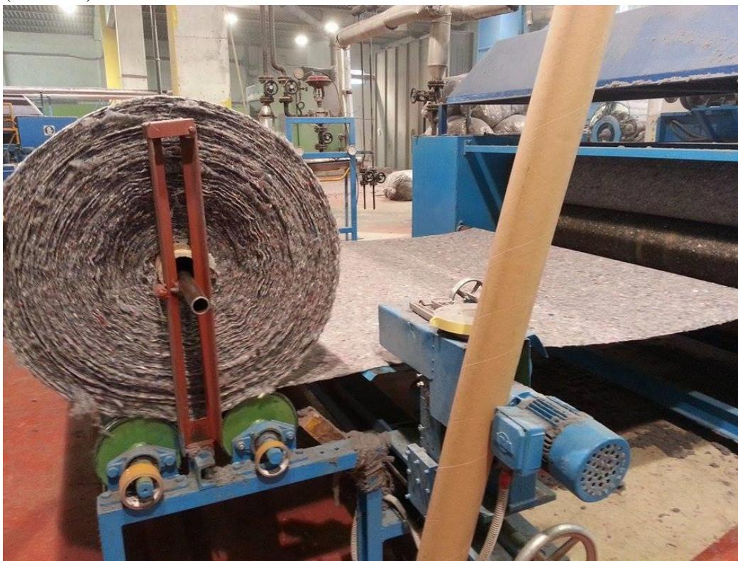
Slika 14. Površinska termička obrada iglanih filčeva i kalibriranje.
