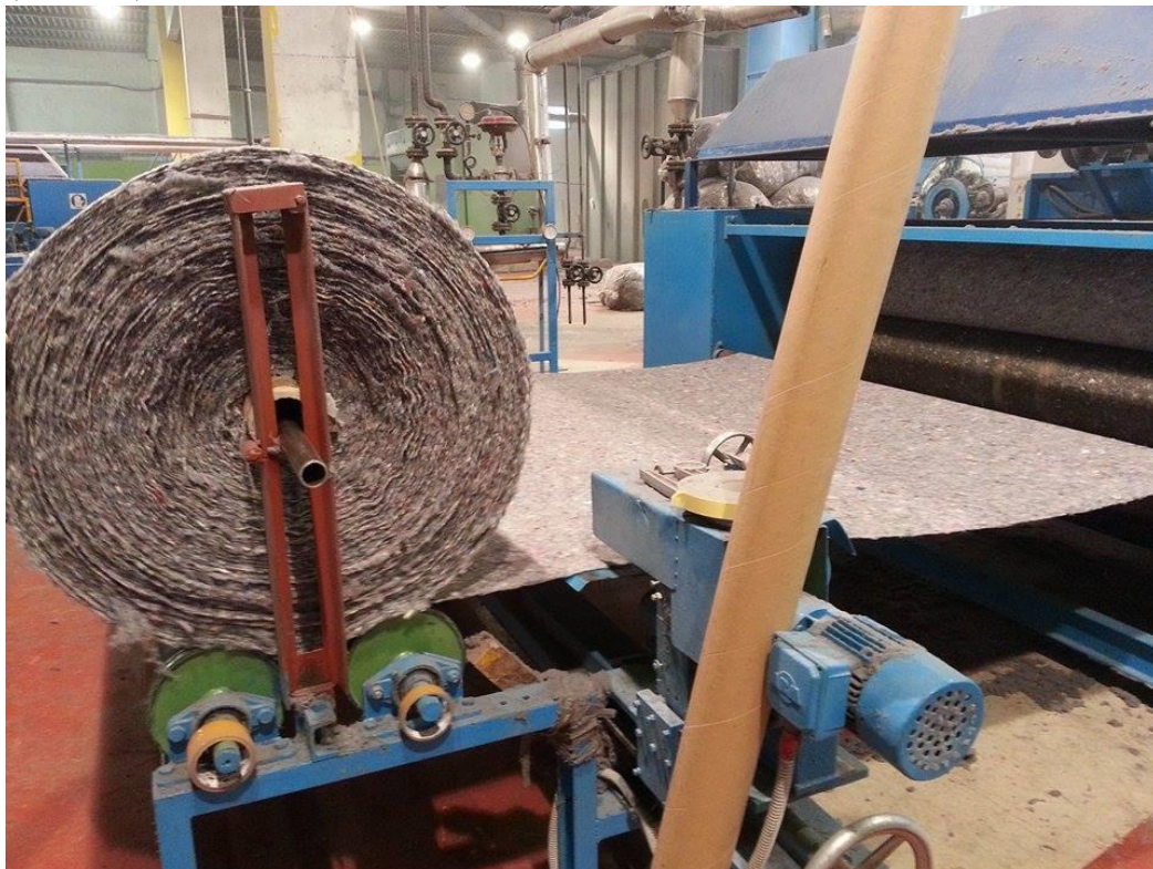
Slika 14. Površinska termička obrada iglanih filčeva i kalibriranje.
