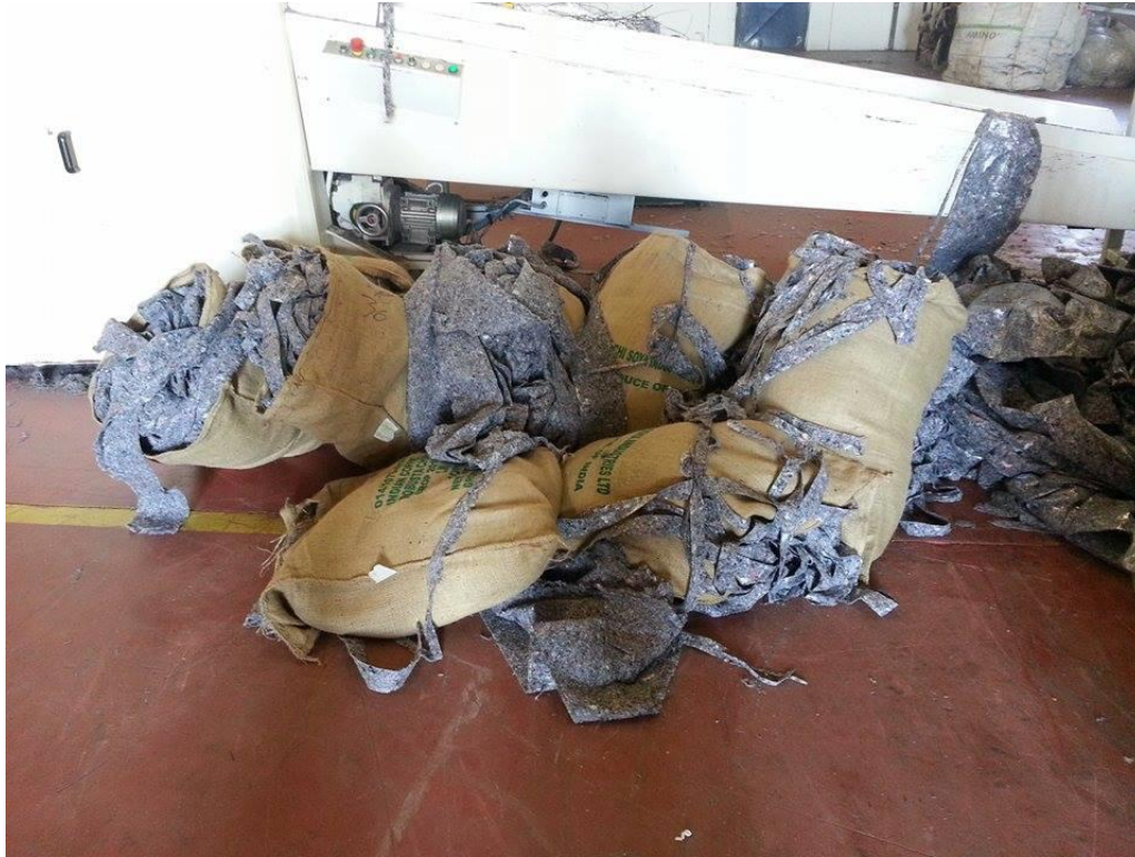
Slika 16. Nastali višak kod rezanja gotovog proizvoda. Materijal se vraća natrag u pogon kao resurs.
