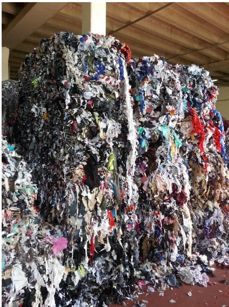
Slika 7. Poluproizvod dobiven nakon miješanja usitnjenih dijelova odjevnih predmeta sa tehničkim tekstilom.
