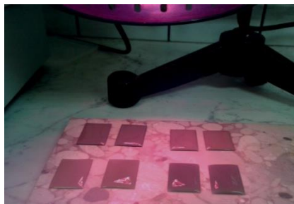
Slika 23. Sušenje orijentiranih preparata pod infracrvenom lampom.
