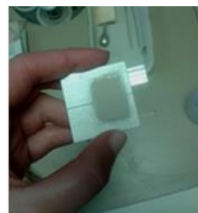
Slika 25. Aluminijski nosač s praškastim uzorkom.
