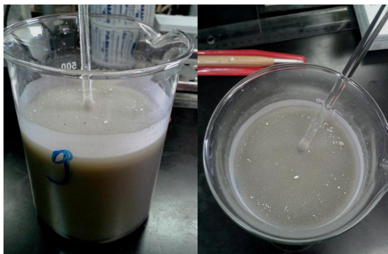
Slika 24. Nakupljanje bijelosive nepoznate materije na površini suspenzije uzorka ET-9.
