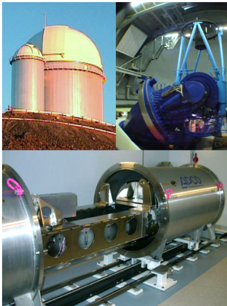
Slika 2.2: Gornja lijeva slika prikazuje zvjezdarnicu u kojoj je smješten ESO 3.6m teleskop, sam teleskop je prikazan na gornjoj slici desno. Donja slika prikazuje HARPS spektrograf prije nego što je zatvoren u vakuumsku komoru [10].
