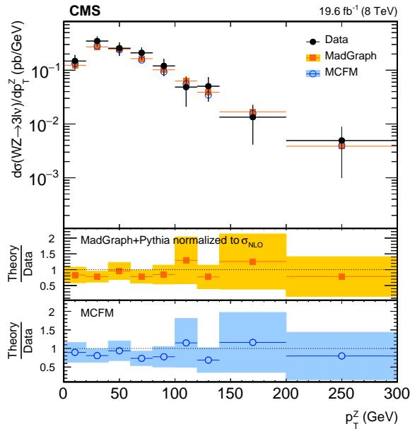
**Figure 9.5:** WZ diferencijalni udarni presjek kao funkcija transverzalnog umpsula Z bozona. Mjerjenje je uspoređeno sa MCFM i MADGRAPH predviđanjima. MADGRAPH predviđanja su skalirana na ukupni NLO udarni presjek koji je predviđen sa MCFM paketom. Relativne greške na podatke su statističke i sistematske i označene su u svakom binu.
