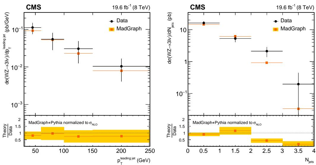
**Figure 9.6:** WZ diferencijalni udarni presjek kao funkcija transverzalnog impula vodećeg mlaza (lijevo) i broja mlazova. Mjerenja su uspoređena sa MADGRAPH predviđanjima. MADGRAPH predviđanja su skalirana na ukupni NLO udarni presjek koji je predviđen sa MCFM paketom. Relativne greške na podatke su statističke i sistematske i označene su u svakom binu.
