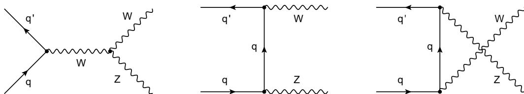
**Figure 9.1:** Feynmanovi dijagrami za  $WZ$  produkciju u prvom redu računa smetnje. Tri dijagrama predstavljaju doprinos (lijevo)  $s$ -kanala kroz TGC, (sredina)  $t$ -kanala, i (desno)  $u$ -kanala.
