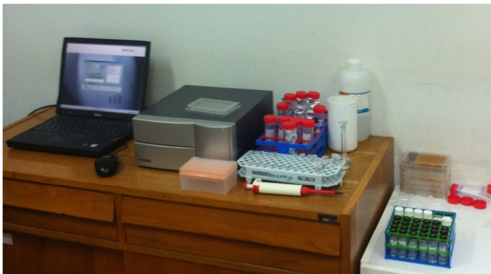
Slika 3.4. Višekanalni spektrofotometarski čitač mikrotitarskih pločica „Sunrise“ ( Tecan GmbH , Austria).
