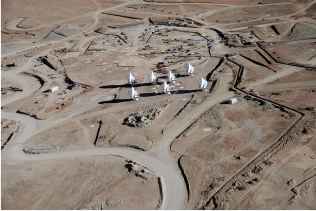
Slika 3.1: Panoramska slika opservatorija ALMA. Na slici se vidi i mreža cesta koja omogućuje pomicanje antena i njihovo razmještanje u različite konfiguracije. Preuzeto iz [9].
