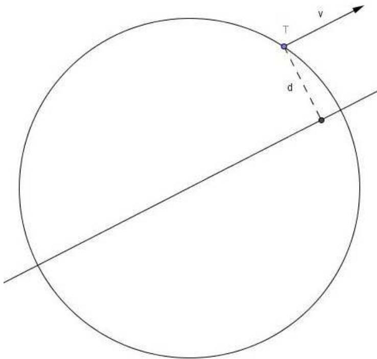
Slika 7.1: 2D varijanta određivanja udaljenosti od središta detektora
