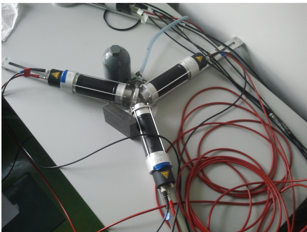
Slika 4.2: Postav detektora oko radioaktivnog izvora
