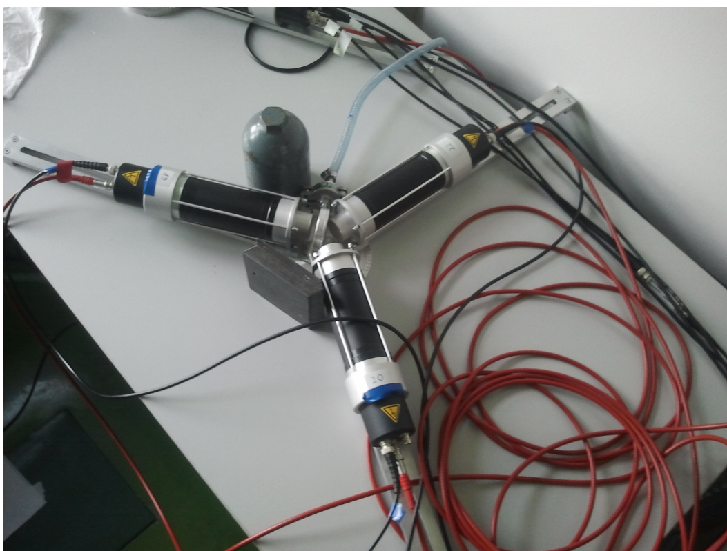
Slika 4.2: Postav detektora oko radioaktivnog izvora
