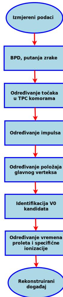
Slika 2.6: Shematski prikaz rekonstrukcijskog lanca.
