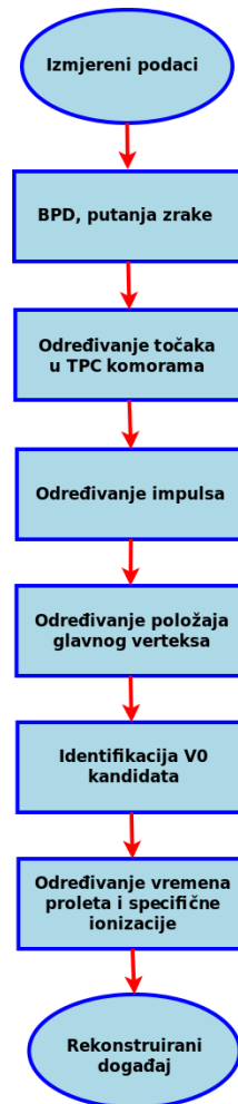
Slika 2.6: Shematski prikaz rekonstrukcijskog lanca.
