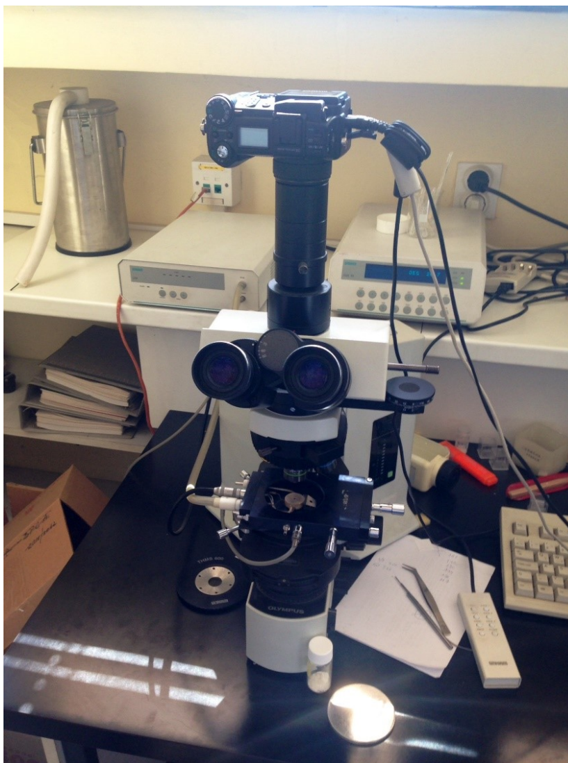
Slika 4.10: Eksperimentalni postav za mikroskopiju s pločom za zagrijavanje
