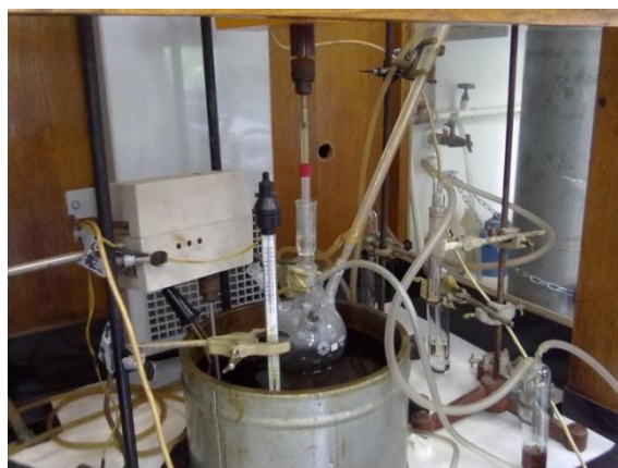
Slika 40 Priprema srebrnih nanočestica redukcijom s citratima u uljnoj kupelji.
