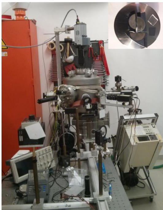
Slika 43 Uređaj za pulsnu lasersku ablaciju (IPCF, Messina, Italija); umetnuta slika prikazuje uzorke neposredno prije pulsne laserske ablacije.
