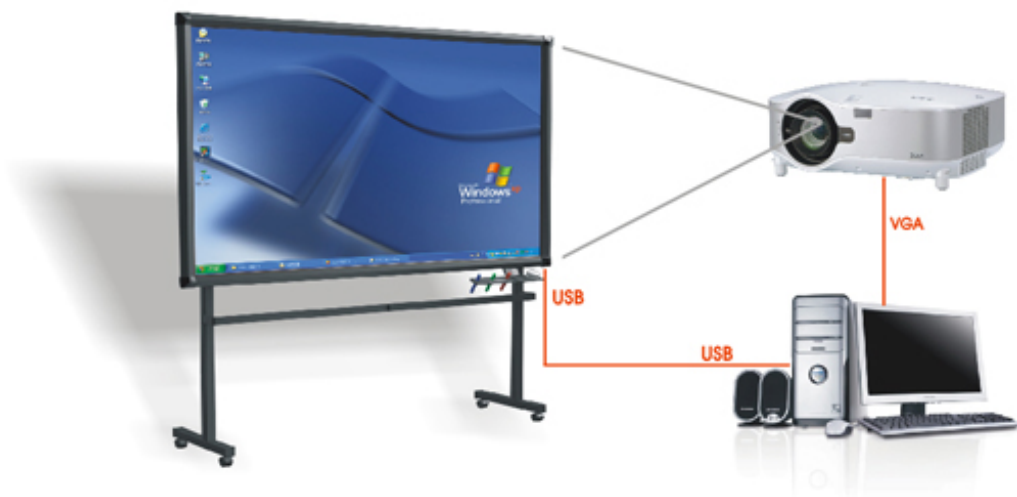
Slika 3.2: Interaktivna ploča s projektorom i računalom
