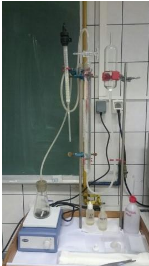
Slika 9. Scheiblerov kalcimetar, Mineraloško-petrografski zavod PMF-a.
