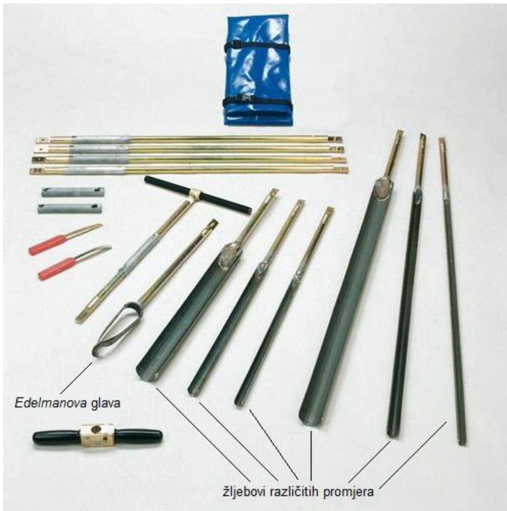
Slika 6. Korer marke Eijkelkamp s označenim pojedinim dijelovima (modificirano prema izvoru: https://en.eijkelkamp.com/products/augering-soil-sampling-equipment/bi-partite-gouge-auger-set-sa.html , travanj 2017).
