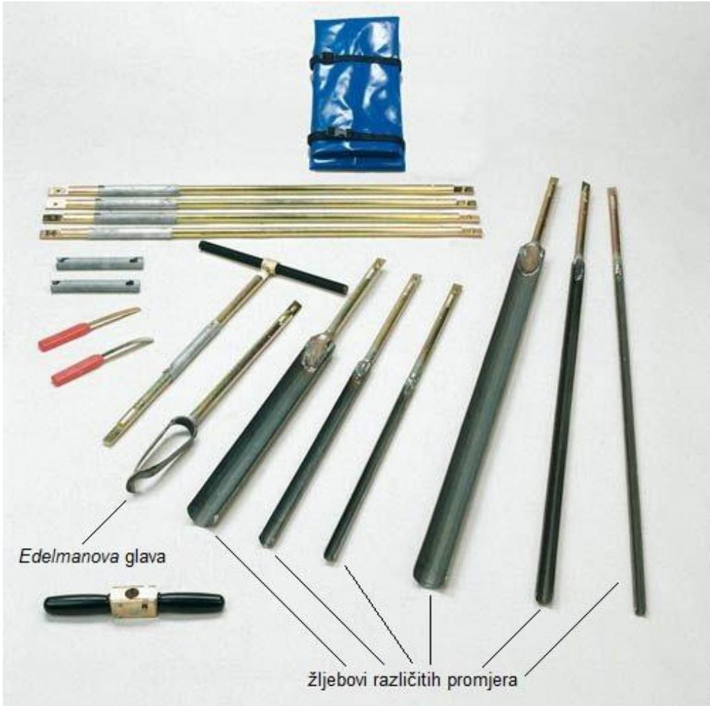
**Slika 6.** Korer marke Eijkelkamp s označenim pojedinim dijelovima (modificirano prema izvoru:
