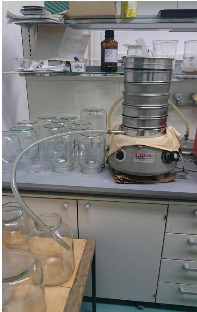
**Slika 7.** Set Retsch® ASTM sita pričvršćenih na tresilicu Fritcsh Analysette®, Geološko-paleontološki zavod PMF-a.
