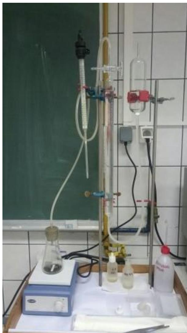
**Slika 9.** Scheiblerov kalcimetar, Mineraloško-petrografski zavod PMF-a.
