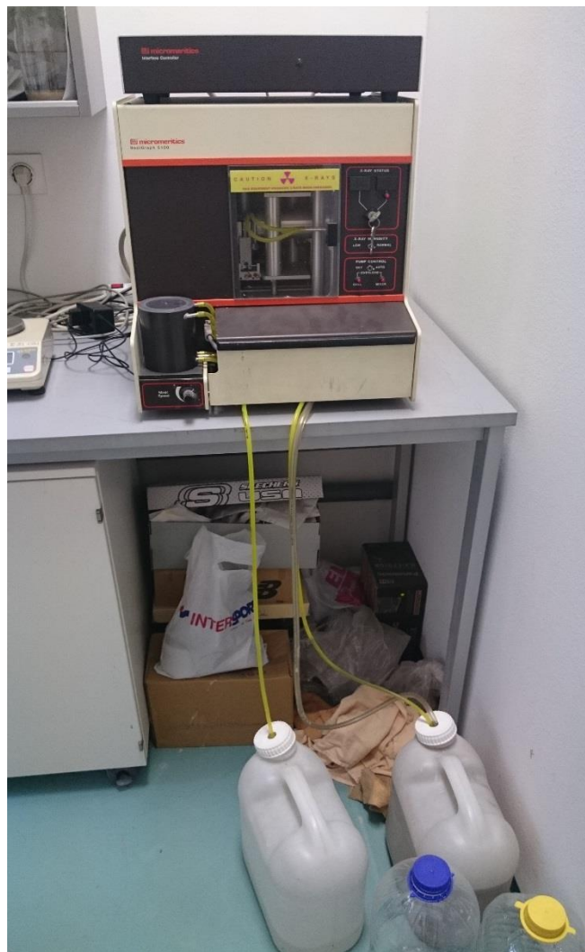
Slika 8. SediGraph 5100, Geološko-paleontološki zavod PMF-a.
