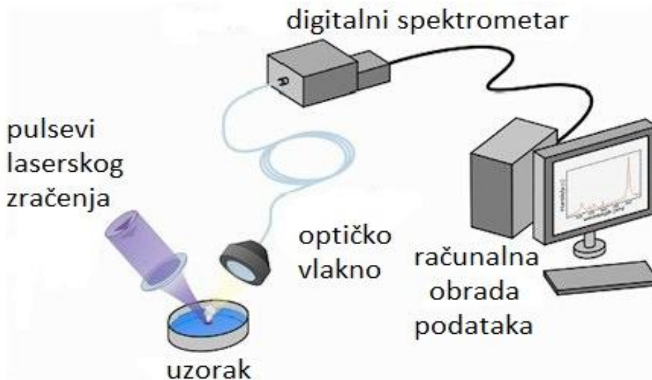
Slika 4. Standardni postav za izvođenje laserom inducirane fluorescencije ( http://www.tut.fi/cs/groups/public/@l611/@web/@p/documents/kuva/mdbw/mdqy/~edisp/p042755.jpg )
