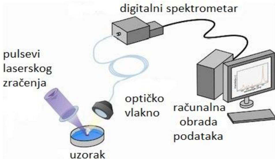
Slika 4. Standardni postav za izvođenje laserom inducirane fluorescencije
