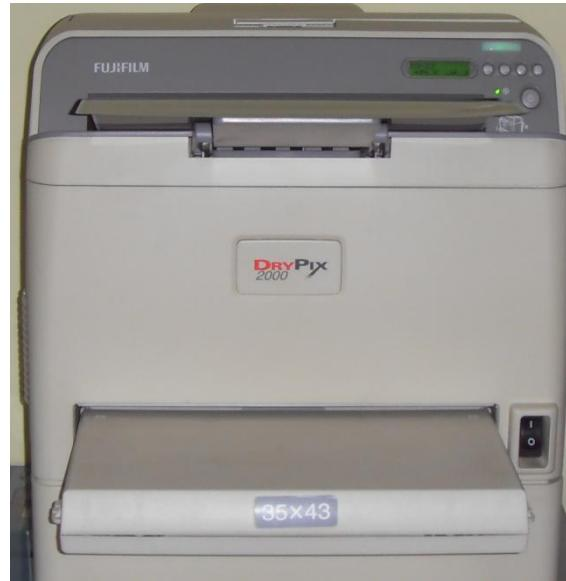
Slika 9. Instrument Fujifilm DryPix 2000 korišten za izradu rendgenskih snimki
