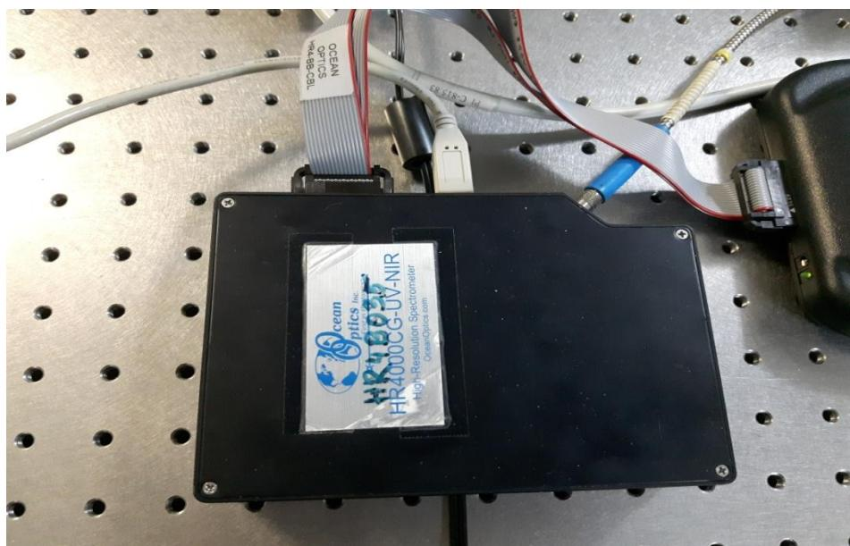
Slika 5. Digitalni spektrometar korišten za LIF analizu
