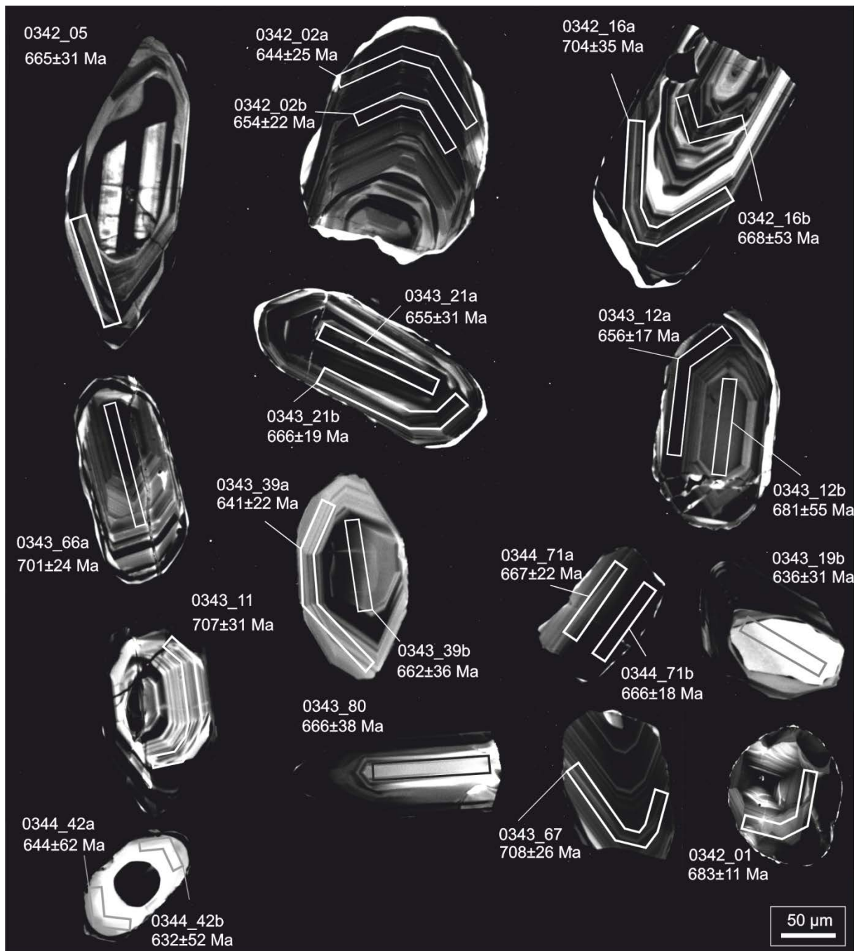
Slika 4.20. CL snimke cirkona prve podgrupe iz četvrte grupe (4.1.) (uzorak ST-6), s naznačenim trasama mjerenja i pripadajućim starostima. Promjer zrake mjerenja je 10-15 µm, na slici je ucrtano približno.
