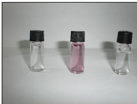
Slika 79: Fotografija bočica prilikom izvedbe pokusa pripreve kompleksa s prijenosom naboja između spoja 3a i tropilijevog tetrafluoroborata u omjeru 1:3
