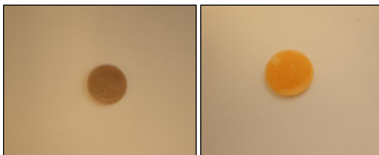
Slika 87: KBr pastila pripravljena iz taloga smjese spoja 1 i DDQ i spoja 2a i DDQ
