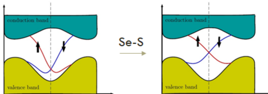
Slika 4.10: Shematski prikaz pomicanja Diracove točke zamjenjivanjem selenija sumporom. Diracova se točka energetske pomiče od stanja valentne vrpce pa su efekti topološkog izolatora izraženiji.
