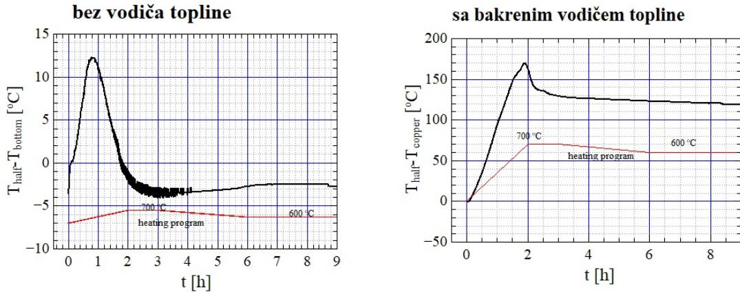
Slika 5.3: Razlike u temperaturi sredine i dna ampule bez bakrenog vodiča topline (lijevo) i sa bakrenim vodičem topline (desno). Program grijanja peći je od sobne temperature do  $700^{\circ}\text{C}$  u tri sata, zatim se spušta kroz tri sata do  $600^{\circ}\text{C}$  i tamo se zadržava do završetka.
