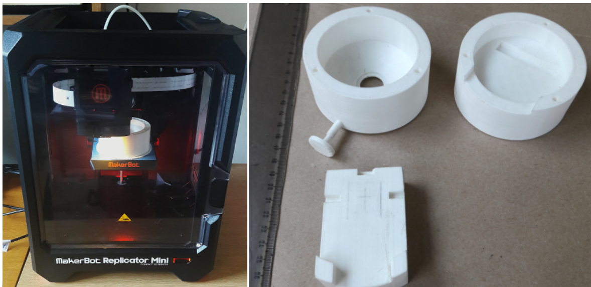
Slika A.3: Lijevo: printanje makete u procesu. Desno: isprintana maketa uključuje gornju i donju ćeliju, te platformu za uzorke.
