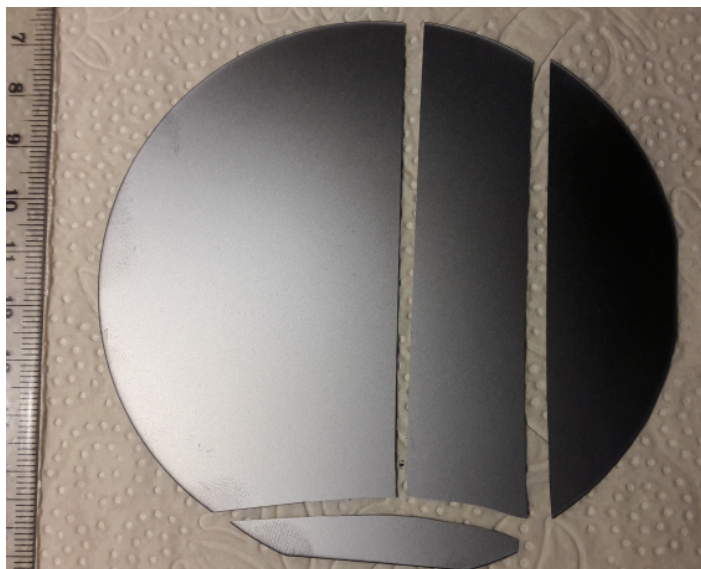
Slika 3.9: Kalanje silicijeve pločice duž kristalnih ravnina.
