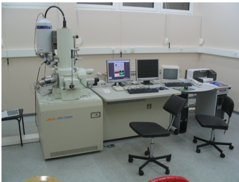
Slika 4.13: Skenirajući elektronski mikroskop JSM 7000F Zavoda za kemiju materijala, Instituta Ruđer Bošković.
