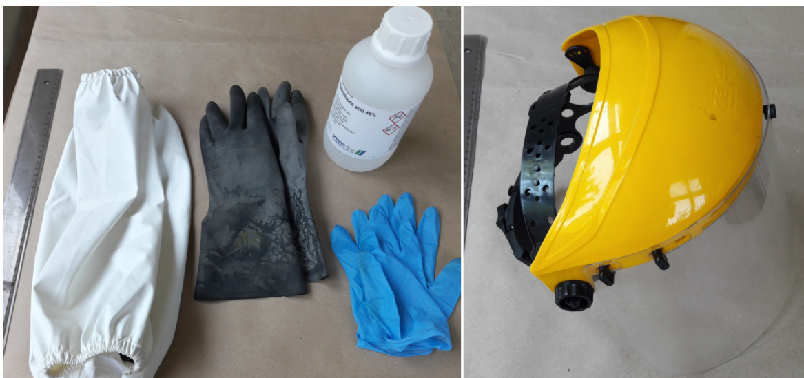
Slika C.1: Zaštitna oprema za rukovanje s fluorovodičnom kiselinom. Plave nitrilne rukavice, crne debele rukavice, manšete i vizir za lice. Nisu prikazani kuta i pregača.
