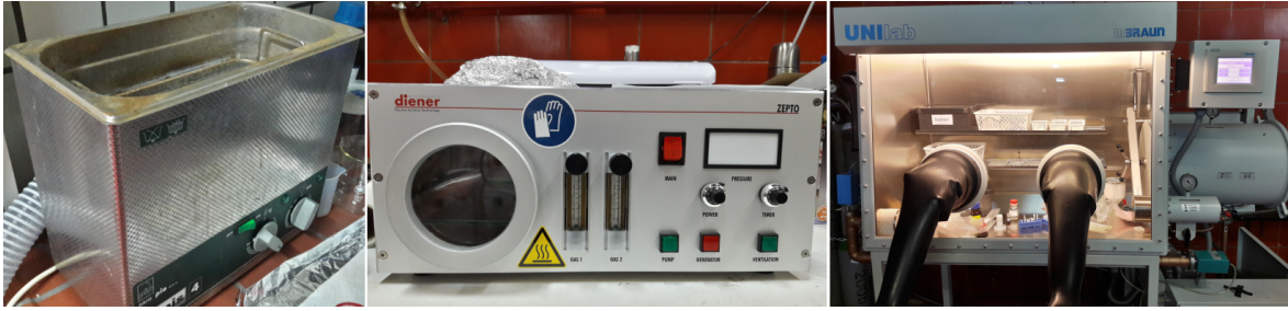
Slika 3.10: Lijevo: ultrazvučna kupelj za čišćenje površinskih nečistoća s uzoraka. Sredina: plasma cleaner za čišćenje mikroskopskih nečistoća. Desno: glove-box s kontroliranom atmosferom za pohranu uzoraka.
