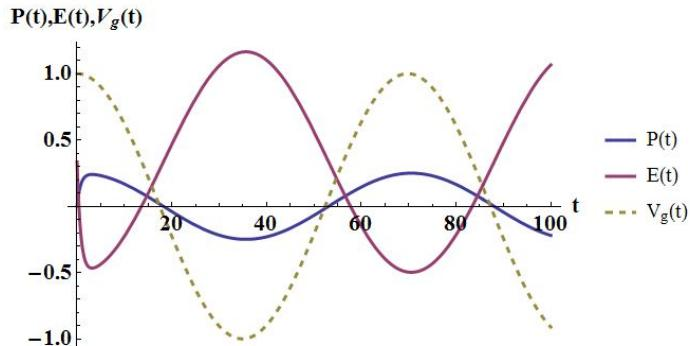
Slika 7.9: Prikaz ovisnosti polarizacije  $P$ , električnog polja unutar feroelektrika  $E$  i prednapona  $V_g$  o vremenu za kontinuirani fazni prijelaz za slučaj kada  $A < \frac{1}{|\alpha|}$  i  $\omega \ll |a|$ . Graf ovisnosti je napravljen u programu *Wolfram Mathematica* za izabrane vrijednosti koeficijenata  $|\alpha| = 2$ ,  $\beta = 0$  i parametra  $\rho = 1$ ,  $A = 0.3$ ,  $B_0 = 0.1$ ,  $\omega = 0.09$ ,  $V_{g0} = 1$  i  $P_0 = 0$ .
