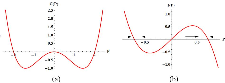
Slika 6.2: Ovisnosti (a)  $G(P)$  i (b)  $f(P)$  za fazni prijelaz drugog reda kada se sustav ne nalazi u vanjskom električnom polju. Grafovi su napravljeni u programu *Wolfram Mathematica* za izabrane koeficijente  $|\alpha| = 2$  i  $\beta = 4$ .
