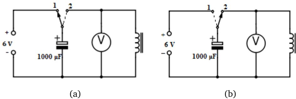
Slika 10.1: Shematski prikaz električnog titravnog strujnog kruga kada se u strujnom krugu nalaze (a) izvor istosmjernog napona od 6 V i kondenzator kapaciteta  $1000 \mu F$  i (b) kondenzator kapaciteta  $1000 \mu F$  i zavojnica školskog transformatora od 3600 zavoja na željeznoj jezgri s paralelno spojenim demonstracijskim voltmetrom.
