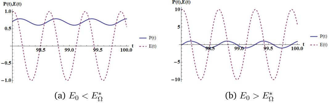
Slika 6.8: Ovisnosti  $P(t)$  (puna linija) i  $E(t)$  (isprekidana linija) za fazni prijelaz drugog reda za tranzijentan slučaj  $\Omega \gg 1$ . Grafovi su napravljeni u programu *Wolfram Mathematica* za izabrane koeficijente  $|\alpha| = 2$  i  $\beta = 4$  te parametre  $\Omega = 10$ ,  $P(t = 0) = 0, 1$ , (a)  $E_0 = 1$  i (b)  $E_0 = 10$ .
