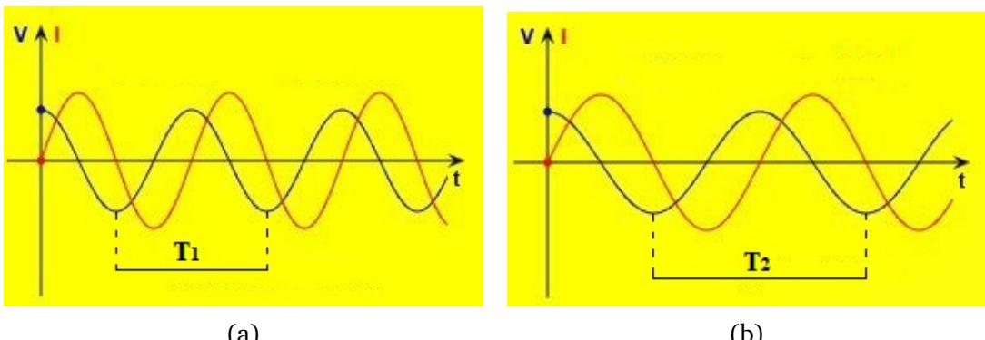
Slika 10.5: Prikaz napona i struje o vremenu u električnom titrajnom krugu ( $R = 0$ ) za konstantan induktivitet zavojnice  $L = 10 \text{ H}$  i kapacitete (a)  $C = 500 \mu\text{F}$  i (b)  $C = 1000 \mu\text{F}$ .
