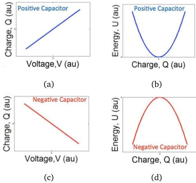
Slika 3.1: Prikaz ovisnosti naboja  $Q$  na kondenzatoru o naponu  $V$  za (a) kondenzator pozitivnog kapaciteta i (c) negativnog kapaciteta te ovisnosti slobodne energije  $U$  o naboju za (b) kondenzator pozitivnog kapaciteta i (d) negativnog kapaciteta. Slike preuzete iz [6].
