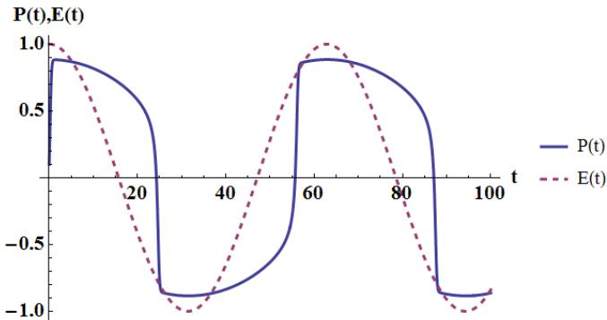
Slika 6.7: Graf ovisnosti polarizacije  $P(t)$  (puna linija) i vanjskog električnog polja  $E(t)$  (isprikidana linija) o vremenu za kvazistacionaran slučaj kada  $\Omega \ll 1$  i  $E_0 > E_{krit}$ . Graf je napravljen u programu *Wolfram Mathematica* za izabrane koeficijente  $|\alpha| = 2$  i  $\beta = 4$  te parametre  $E_0 = 1$ ,  $\Omega = 0, 1$  i  $P(t = 0) = 0, 1$ .
