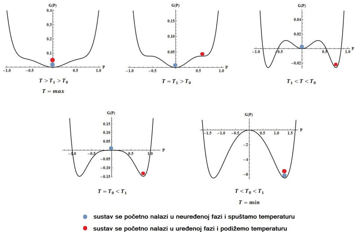
Slika 5.9: Ovisnost Gibssove slobodne energije o polarizaciji za različite temperature. Ovisno o tome nalazi li se sustav u uređenoj ili neuređenoj fazi te podižemo li ili spuštamo temperaturu do faznog prijelaza dolazi na temperaturi  $T_1$ , odnosno  $T_0$ . Crveni, odnosno plavi krug prikazuje evoluciju sustava s promjenom temperature.
