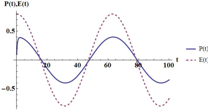
Slika 6.9: Graf ovisnosti polarizacije  $P(t)$  (puna linija) i vanjskog električnog polja  $E(t)$  (isprekidana linija) o vremenu za slučaj kada  $\Omega \ll \alpha$ . Graf je napravljen u programu *Wolfram Mathematica* za izabrane koeficijente  $\alpha = 2$  i parametre  $E_0 = 0,8$ ,  $\Omega = 0,1$  i  $P(t = 0) = 0,1$ .
