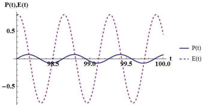
Slika 6.10: Graf ovisnosti polarizacije  $P(t)$  (puna linija) i vanjskog električnog polja  $E(t)$  (isprekidana linija) o vremenu za slučaj kada  $\Omega \gg \alpha$ . Graf je napravljen u programu *Wolfram Mathematica* za izabrane koeficijente  $\alpha = 2$  i parametre  $E_0 = 0,8$ ,  $\Omega = 10$  i  $P(t = 0) = 0,1$ .
