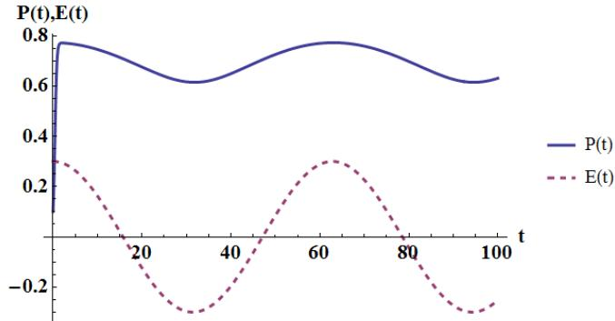
Slika 6.5: Graf ovisnosti polarizacije  $P(t)$  (puna linija) i vanjskog električnog polja  $E(t)$  (isprekidana linija) o vremenu za kvazistacionaran slučaj kada  $\Omega \ll 1$  i  $E_0 < E_{krit}$ . Graf je napravljen u programu *Wolfram Mathematica* za izabrane koeficijente  $|\alpha| = 2$  i  $\beta = 4$  te parametre  $E_0 = 0, 3$ ,  $\Omega = 0, 1$  i  $P(t = 0) = 0, 1$ .
