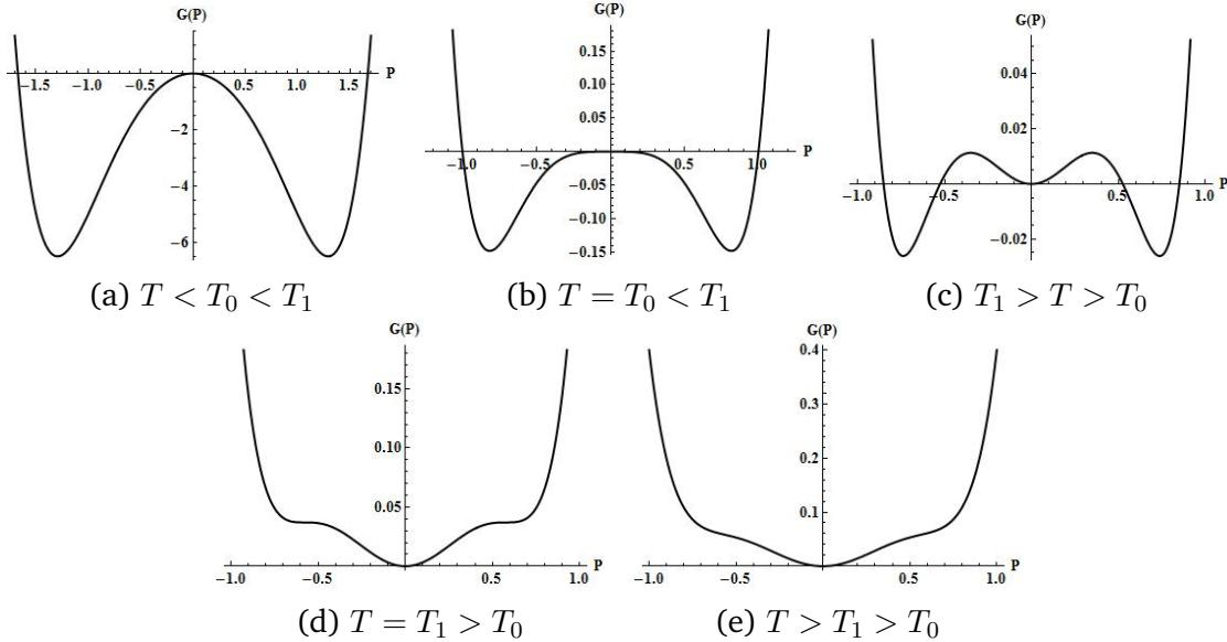
Slika 5.7: Ovisnost slobodne energije o polarizaciji za fazni prijelaz prvog reda na različitim temperaturama. Grafovi su napravljeni u programu *Wolfram Mathematica* za izabrane koeficijente  $\alpha_0 = 2$ ,  $\beta = -4$ ,  $\gamma = 6$  i temperaturu  $T_0 = 5$  u proizvoljnim mjerljivim jedinicama.
