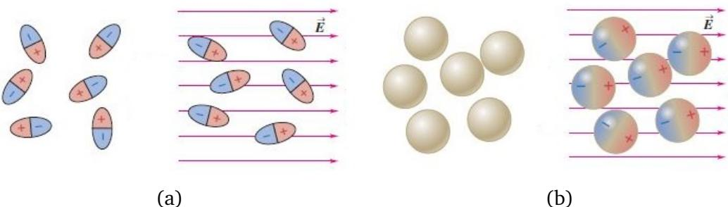
Slika 2.3: Prikaz (a) polarnih molekula kada je  $E = 0$  (lijevo) i u prisustvu električnog polja (desno) te (b) nepolarnih molekula kada je  $E = 0$  (lijevo) i u prisustvu električnog polja (desno). Slike preuzete iz [10].
