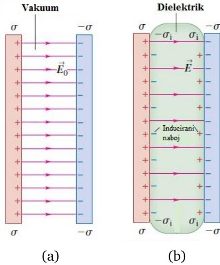
Slika 2.2: Prikaz silnica električnog polja za kondenzator između čijih ploča se nalazi (a) vakuuum i (b) dielektrik. Slike preuzete iz [10].
