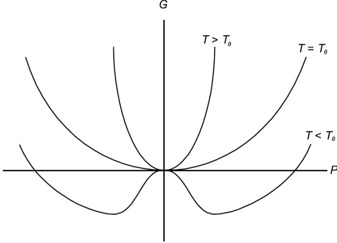
Slika 5.3: Ovisnost Gibbsove slobodne energije o polarizaciji kod faznog prijelaza drugog reda za tri različite temperature  $T < T_0$ ,  $T = T_0$  i  $T > T_0$  gdje  $T_0$  predstavlja temperaturu prijelaza. Slika preuzeta iz [28].
