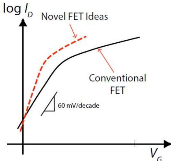
Slika 8.2: Prikaz ovisnosti logaritamske vrijednosti struje odvoda  $\log_{10}I_D$  o naponu na vrata tranzistora  $V_g$  za standardne tranzistore s efektom polja (puna crna linja) i tranzistore s efektom polja gdje se ispod vrata FET-a postavlja dodatni sloj feroelektričnog materijala (isprekidana crvena linija). Slika preuzeta iz [6].
