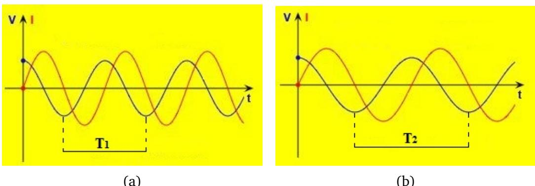
Slika 10.6: Prikaz napona i struje o vremenu u električnom titrajnom krugu ( $R = 0$ ) za konstantan kapacitet kondenzatora  $C = 1000 \mu\text{F}$  i induktiviteti (a)  $L = 5 \text{ H}$  i (b)  $L = 10 \text{ H}$ .
