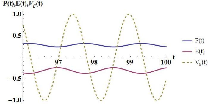
Slika 7.8: Prikaz ovisnosti polarizacije  $P$ , električnog polja unutar feroelektrika  $E$  i prednapona  $V_g$  o vremenu za kontinuirani fazni prijelaz za slučaj kada  $A > \frac{1}{|\alpha|}$ . Graf ovisnosti je napravljen u programu *Wolfram Mathematica* za izabrane vrijednosti koeficijenata  $|\alpha| = 2$ ,  $\beta = 4$  i parametra  $\rho = 1$ ,  $A = 0.6$ ,  $B = 0.1$ ,  $\omega = 4$ ,  $V_{g0} = 1$  i  $P_0 = 0$ .
