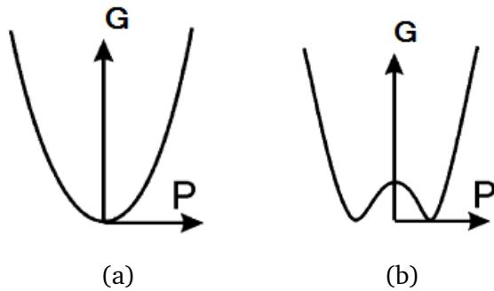
Slika 5.1: Sobodna energija  $G$  kao funkcija polarizacije  $P$  za (a) paraelektrični materijal i (b) feroelektrični materijal. Slika preuzeta iz [24].
