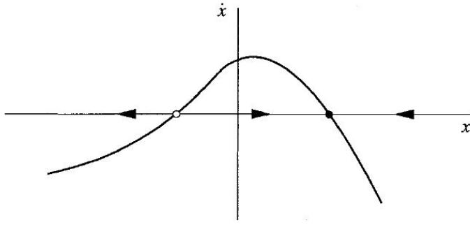
Slika 6.1: Prikaz grafičke analize stabilnosti fiksnih točaka pri rješavanju nelinearne diferencijalne jednadžbe gdje  $\dot{x} = f(x)$ . Slika preuzeta iz [35].
