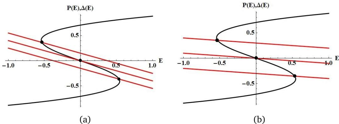
Slika 7.7: Sjedište nabojske linije  $\Delta(E)$  i  $P(E)$  karakteristike feroelektrika kada (a)  $A \approx \frac{1}{|\alpha|}$  i (b)  $A \ll \frac{1}{|\alpha|}$ . Grafovi ovisnosti su napravljeni u programu *Wolfram Mathematica* za izabrane vrijednosti koeficijenata  $|\alpha| = 2$ ,  $\beta = 4$  te parametara (a)  $A = 0.4$ ,  $B \in [-0.15, 0.15]$  i (b)  $A = 0.1$ ,  $B \in [-0.3, 0.3]$ .
