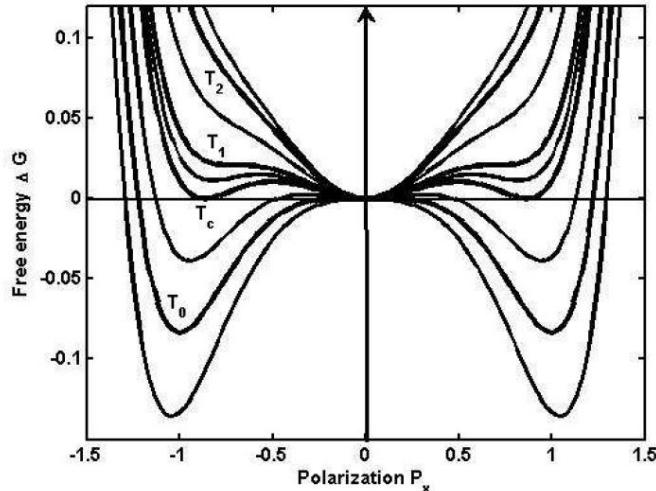
Slika 5.6: Ovisnost slobodne energije o polarizaciji za fazni prijelaz prvog reda paralektrika u feroelektriku za različite temperature. Na slici su označene i četiri karakteristične temperature:  $T_0$ ,  $T_C$ ,  $T_1$  i  $T_2$ . Zbog jednostavnosti, uzete su vrijednosti parametara  $\alpha_0 = 1$ ,  $T_0 = 1$ ,  $\beta = -1$  i  $\gamma = 1$  u proizvoljnim mjerljivim jedinicama. Slika preuzeta iz [27].
