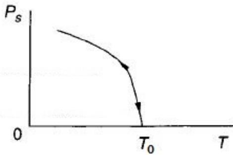
Slika 5.4: Ovisnost polarizacije o temperaturi za fazni prijelaz drugog reda. Za temperature  $T > T_0$  vrijednost polarizacije je jednaka nuli i kontinuirano raste smanjivanjem temperature ispod  $T_0$ . Slika preuzeta iz [29].
