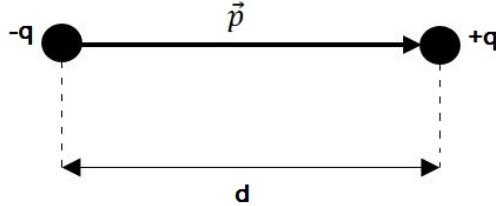
Slika 4.9: Prikaz električnog dipola i dipolnog momenta.
