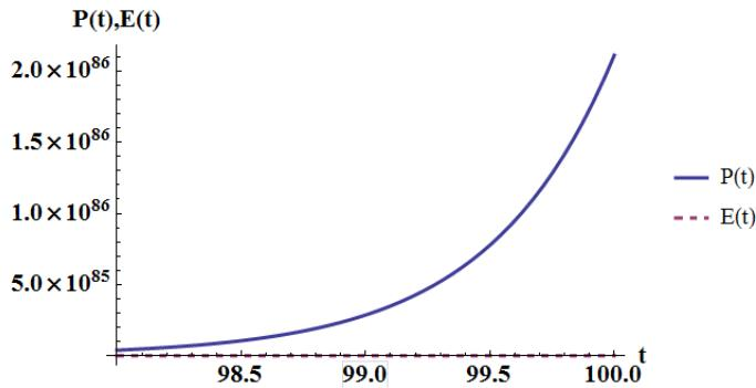
Slika 6.11: Graf ovisnosti polarizacije  $P(t)$  (puna linija) i vanjskog električnog polja  $E(t)$  (isprekidana linija) o vremenu za slučaj nestabilne točke. Graf je napravljen u programu *Wolfram Mathematica* za izabrane koeficijente  $\alpha = -2$  i parametre  $E_0 = 10$ ,  $\Omega = 10$  i  $P(t = 0) = 0, 1$ .
