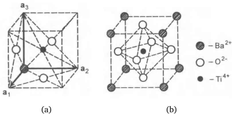
Slika 4.5: (a) Jedinična čelija i (b) strukturalni elementi  $\text{BaTiO}_3$  kristala. Slika preuzeta iz [19].
