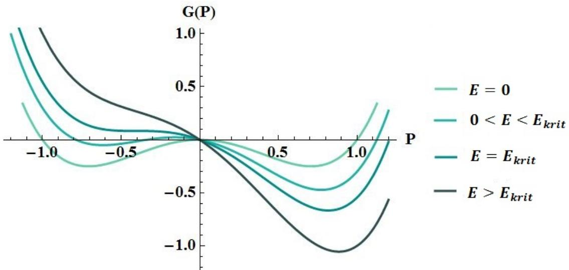
Slika 5.12: Ovisnost slobodne Gibbsove energije o polarizaciji za različite vrijednosti vanjskog električnog polja na konstantnoj temperaturi  $T < T_0$ . Graf ovisnost je napravljen u programu *Wolfram Mathematica* pri čemu su izabrani koeficijenti  $\alpha(T) = -2$  i  $\beta = 4$  za različite vrijednosti vanjskog električnog polja u odnosu na kritično polje  $E_{krit}$  određeno izrazom (5.52).
