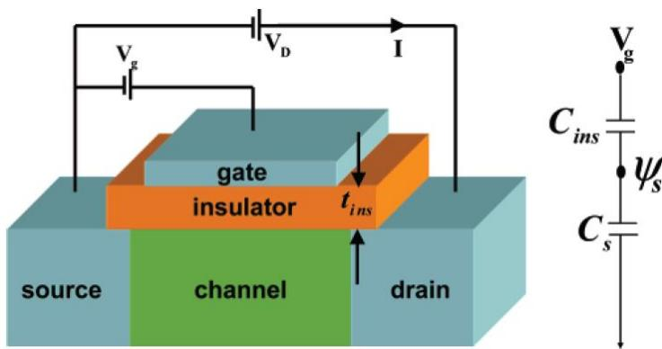
Slika 8.1: Struktura tranzistora s efektom polja (lijevo) gdje struja  $I$  predstavlja struju odvoda koju kontrolira napon na upravljačkoj elektrodi  $V_g$ , i prikaz ekvivalentnog kruga MOSFET-a (desno) za dijeljenje napona između izolatorskog kapaciteta  $C_{ins}$  i poluvodičkog kapaciteta  $C_s$  u kojem su sadržani kapacitet područja osiromašenja, kao i kapaciteti između kanala i izvora te kanala i odvoda tranzistora. Slika preuzeta iz [5].
