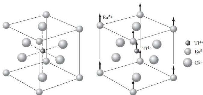
Slika 4.11: Na slici lijevo je prikazana kristalna struktura barijevog titanata u paraelektričnoj fazi, a na slici desno je prikazan pomak iona barija i titana u odnosu na ion kisika zbog čega se javlja dipolni moment. Slika preuzeta iz [21].
