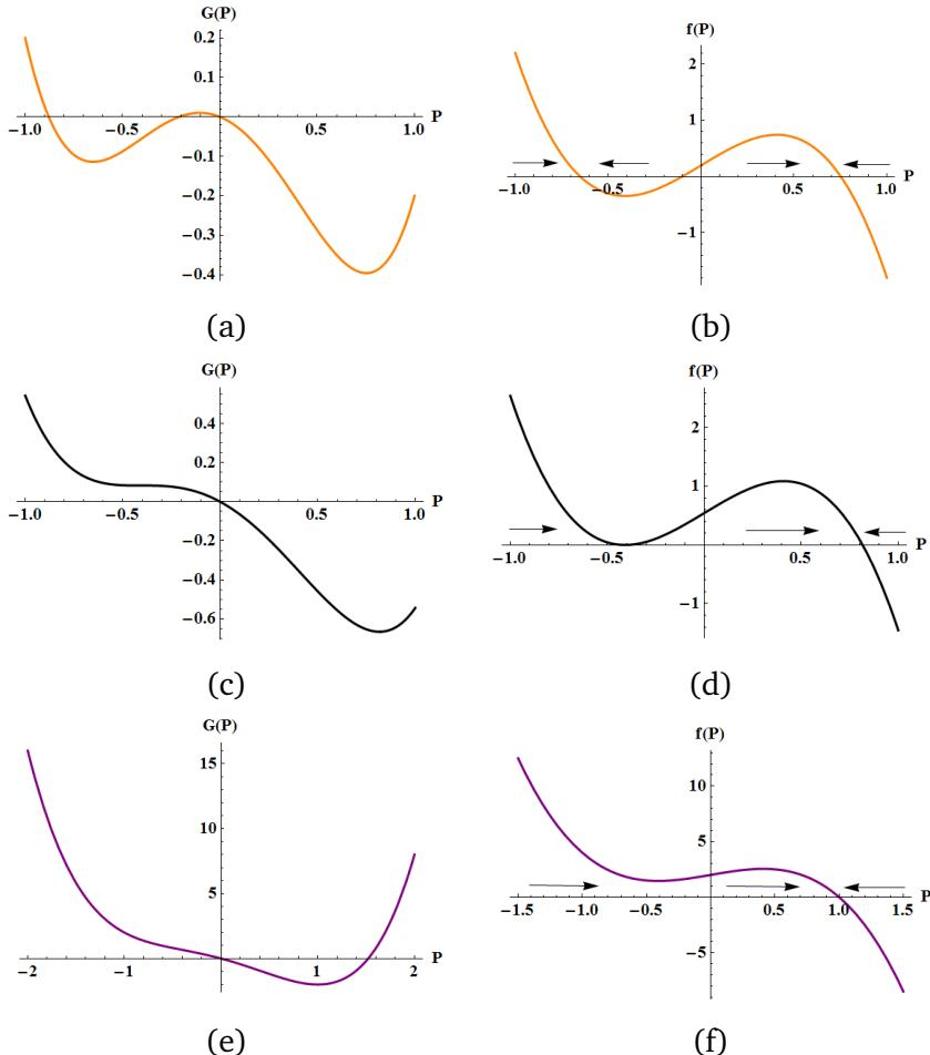
Slika 6.3: Ovisnosti  $f(P)$  i  $G(P)$  za fazni prijelaz drugog reda kada se sustav nalazi u konstantnom vanjskom električnom polju (a),(b)  $E_0 < E_{krit}$ ; (c),(d)  $E_0 = E_{krit}$  i (e),(f)  $E_0 > E_{krit}$ . Grafovi su napravljeni u programu *Wolfram Mathematica* za izabrane koeficijente  $|\alpha| = 2$  i  $\beta = 4$ .
