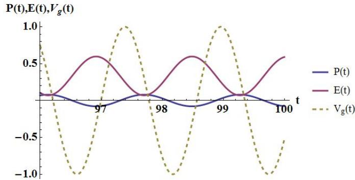
Slika 7.10: Prikaz ovisnosti polarizacije  $P$ , električnog polja unutar feroelektrika  $E$  i prednapona  $V_g$  o vremenu za kontinuirani fazni prijelaz za slučaj kada  $A < \frac{1}{|\alpha|}$  i  $\omega \gg |a|$ . Graf ovisnosti je napravljen u programu *Wolfram Mathematica* za izabrane vrijednosti koeficijenata  $|\alpha| = 2$ ,  $\beta = 0$  i parametra  $\rho = 1$ ,  $A = 0.3$ ,  $B_0 = 0.1$ ,  $\omega = 4$ ,  $V_{g0} = 1$  i  $P_0 = 0$ .
