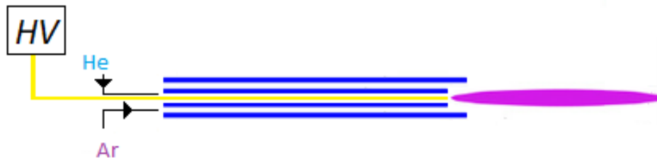
Slika 3.2: Ekperimentalan postav plazmenog mlaza
