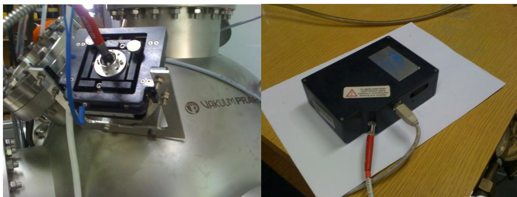
Slika 3.4 a) Detalj priključka optičkog sistema na radnu komoru; b) spektrometar HR 4000 s priključenim optičkim vlaknom i spojen na računalo.
