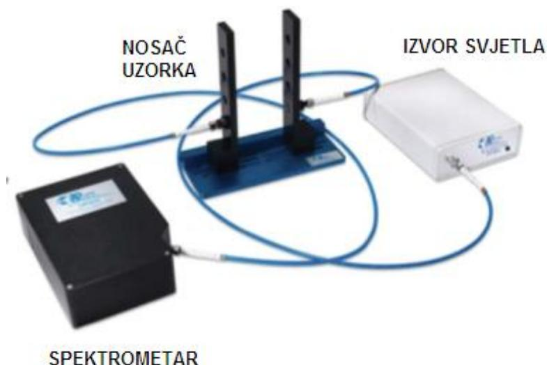
Slika 3.12 Eksperimentalni postav za mjerene faktora transmisije. Naznačeni su osnovni dijelovi: spektrometar, nosač uzorka i izvor svjetla.
