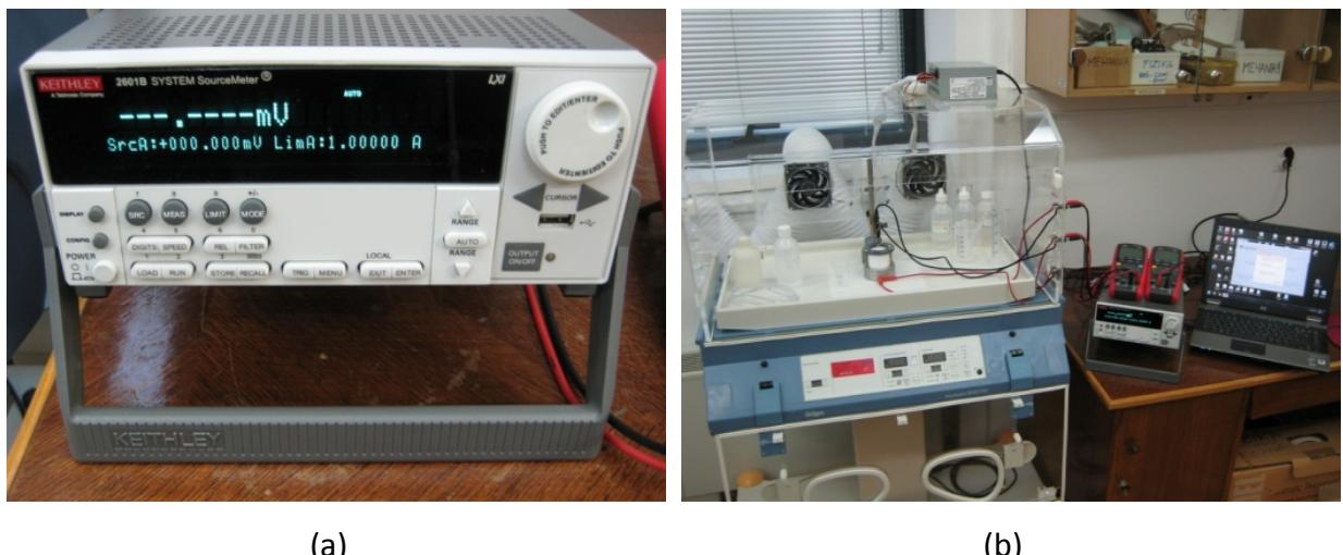
Slika 37. (a) Električni izvor Keithley 2601B SourceMeter. (b). Eksperimentalni postav za izradu poroznog silicija uključuje: digestor, anodizacijsku ćeliju, električni izvor, multimetre.
