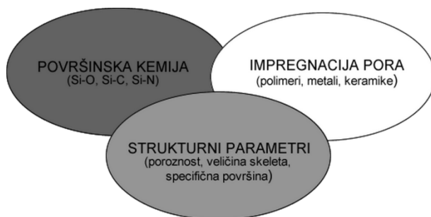
Slika 20. Tri različita pristupa za podešavanje svojstava poroznog silicija.
