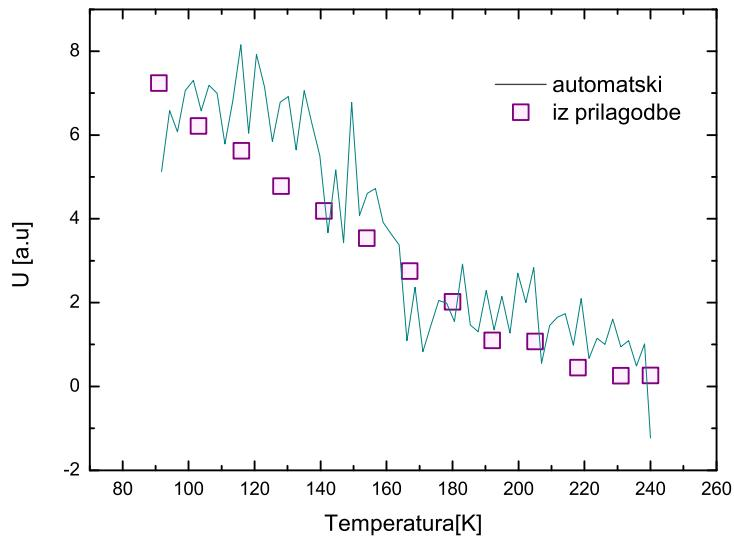
Slika 4.3: Ovisnost "prugastosti" YBCO-a (odnosno visine stepenice u nelinearnom odgovoru  $U$ ) o temperaturi, dobivena iz istih mjerjenja na različite načine. Točke su dobivene ručnom prilagodbom rješenja modela za nabojski smektički smetnik, dok je crta omjer integrala na višim snagama i onog na nižim. Iako je šum znatno veći kod automatizirane analize, kvalitativno je signal isti.
