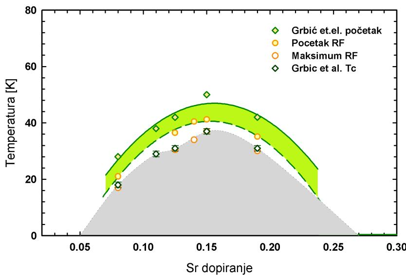
Slika B.4: Fazni dijagram LSCO-a. Temperature maksimuma odgovaraju  $T_c$ , kako su je odredili Grbić et al. [2] Niti početak nelinearnog odgovora niti supravodljive fluktuacije ne slijede potisnuće  $T_c$  na dopiranju  $p = 1/8$ , što ide u prilog teoriji o dvodimenzionalnoj supravodljivosti na tom dopiranju.
