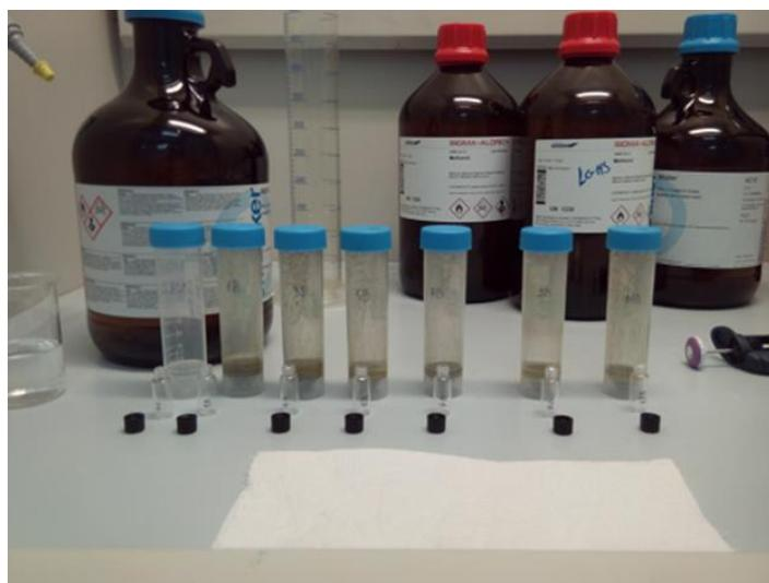
**Slika 14.** Polipropilenske kivete ( $V = 50 \text{ mL}$ ) s uzorkom nakon ekstrakcije i centrifugiranja te staklene posudice s epom ( $V = 2 \text{ mL}$ )
