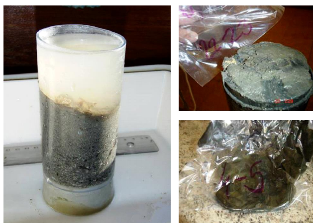
Slika 11. Uzorkovana jezgra sedimenta u plasti noj cijevi korera i poduzorci sedimenta
