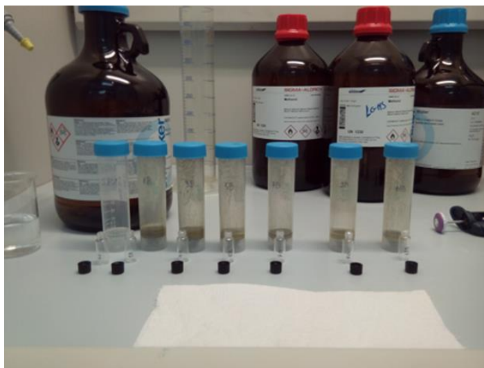
Slika 14. Polipropilenske kivete ( V = 50 mL) s uzorkom nakon ekstrakcije i centrifugiranja te staklene posudice s epom ( V = 2 mL)
