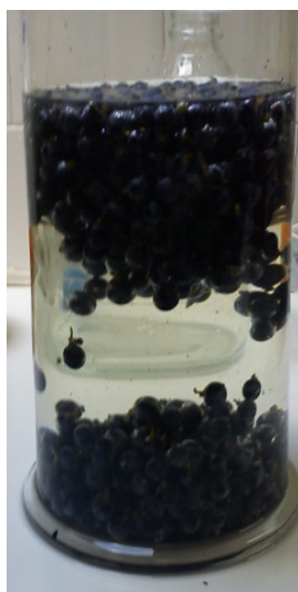
Slika 3.3. Postupak flotacije bobica grožđa
