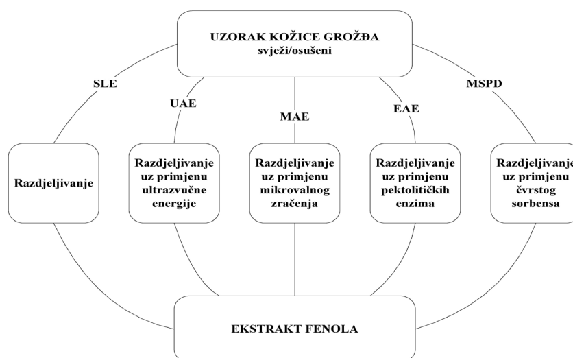
Slika 2.18. Shematski prikaz različitih ekstrakcijskih tehnika
