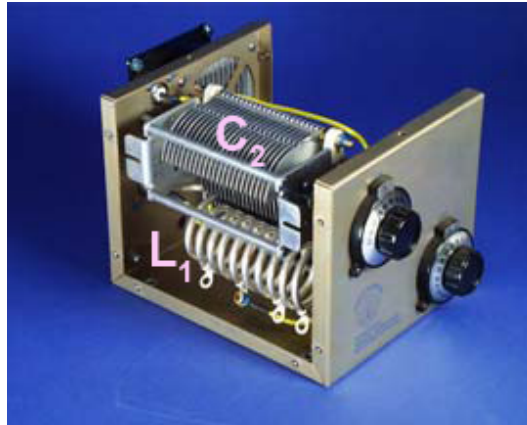
Slika 4.3: Fotografija sklopa za podešavanje impedancije
