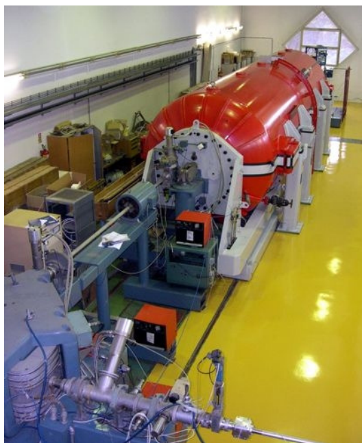
Slika 31. 6 MV EN Tandem Van de Graaff ubrzivač na Institutu ruđer Bošković. Na slici dolje lijevo vidi se dipolni skretni magnet (analizator) koji skreće ionski snop za 90^{\circ} te se koristi za selekciju nabojnog stanja ionskog snopa.
