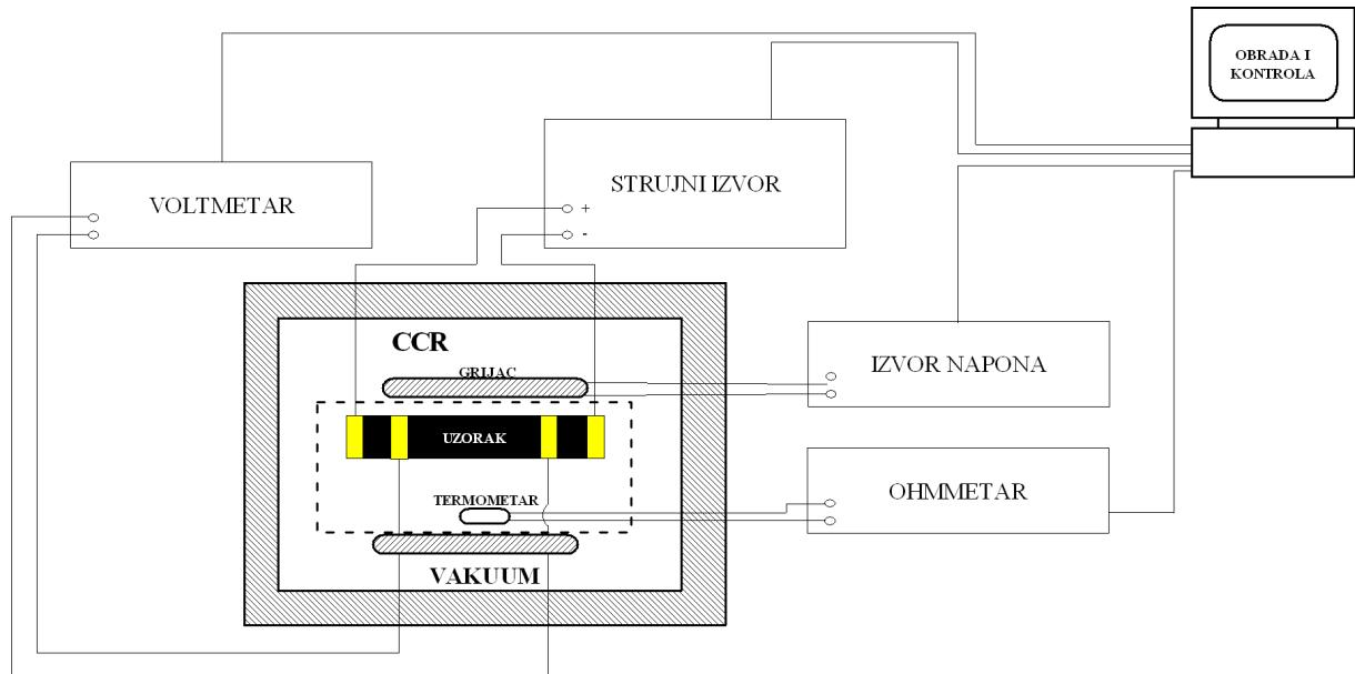
Slika 49 blok shema postava mjerjenja nelinearnog otpora.
