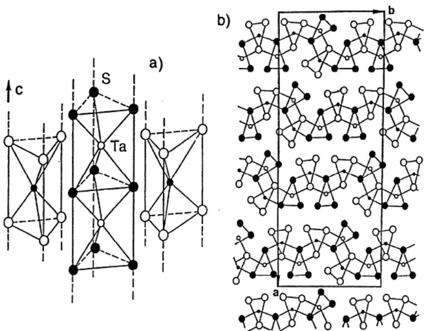
Slika 7 struktura unutar lanaca kristala o- $\text{TaS}_3$  (a). Jedinična celija sadrži 24 lanaca (b).
