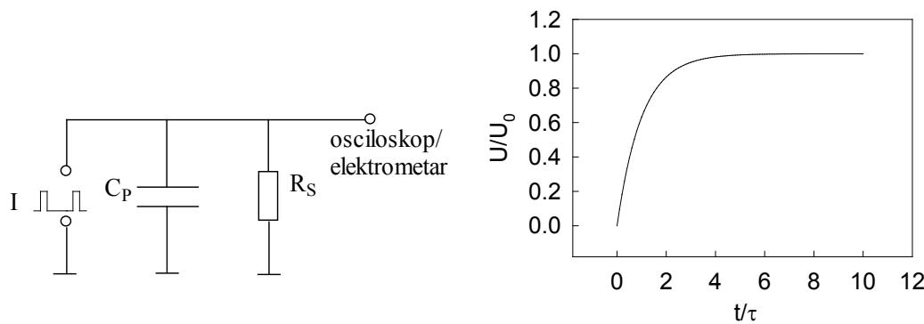
Slika 50 lijevo: pojednostavljena (dvokontaktna) shema eksperimenta sa parazitskim kapacitetom  $C_P$  i strujnim izvorom. Napon na uzorku ( $R_S$ ) se očitava osciloskopom ili elektrometrom. Desno: vremenski odziv ovakvog sustava.
