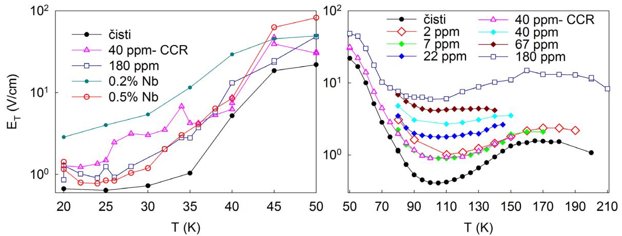
Slika 70 polja praga čistoga uzroka, te ozračenih i dopiranih uzorka na niskim temperaturama (lijevo) i visokim temperaturama (desno).
