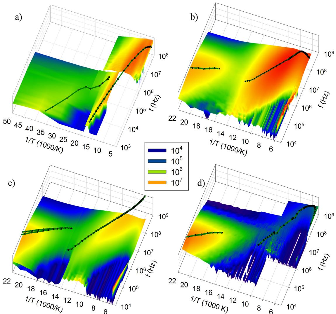
Slika 88 3D plotovi imaginarnog dijela dielektričnog odziva u jedinicama  $\epsilon_0$  u ovisnosti o inverzu temperature i frekvencije u a) čistom uzorku, b) ozračenom uzorku sa 2.2 ppm defekata, c) ozračenom uzorku sa 67 ppm defekata, d) ozračenom uzorku sa 220 ppm defekata. Linije sa crnim točkama označavaju inverz relaksacijskih vremena u ovisnosti o inverzu temperature, odnosno vrhove frekventnih karakteristika za konstantne temperature.
