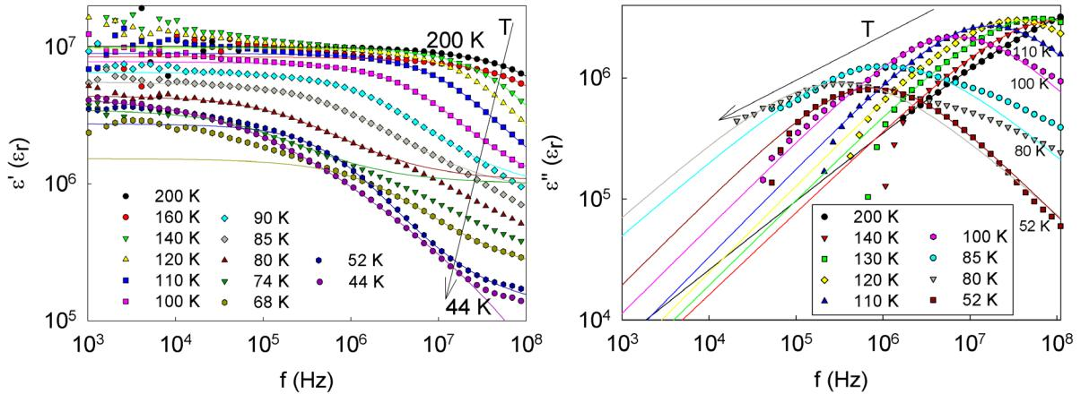
Slika 85 krivulje prilagodbe (linije) za realni (lijevo) i imaginarni (desno) dio dielektričnog odziva (kružići) na više temperature za uzorak sa 22 ppm nivoa ozračenja. Strelice pokazuju smjer snižavanja temperature. Također, radi jasnoće su istaknute temperature neke od krivulja.
