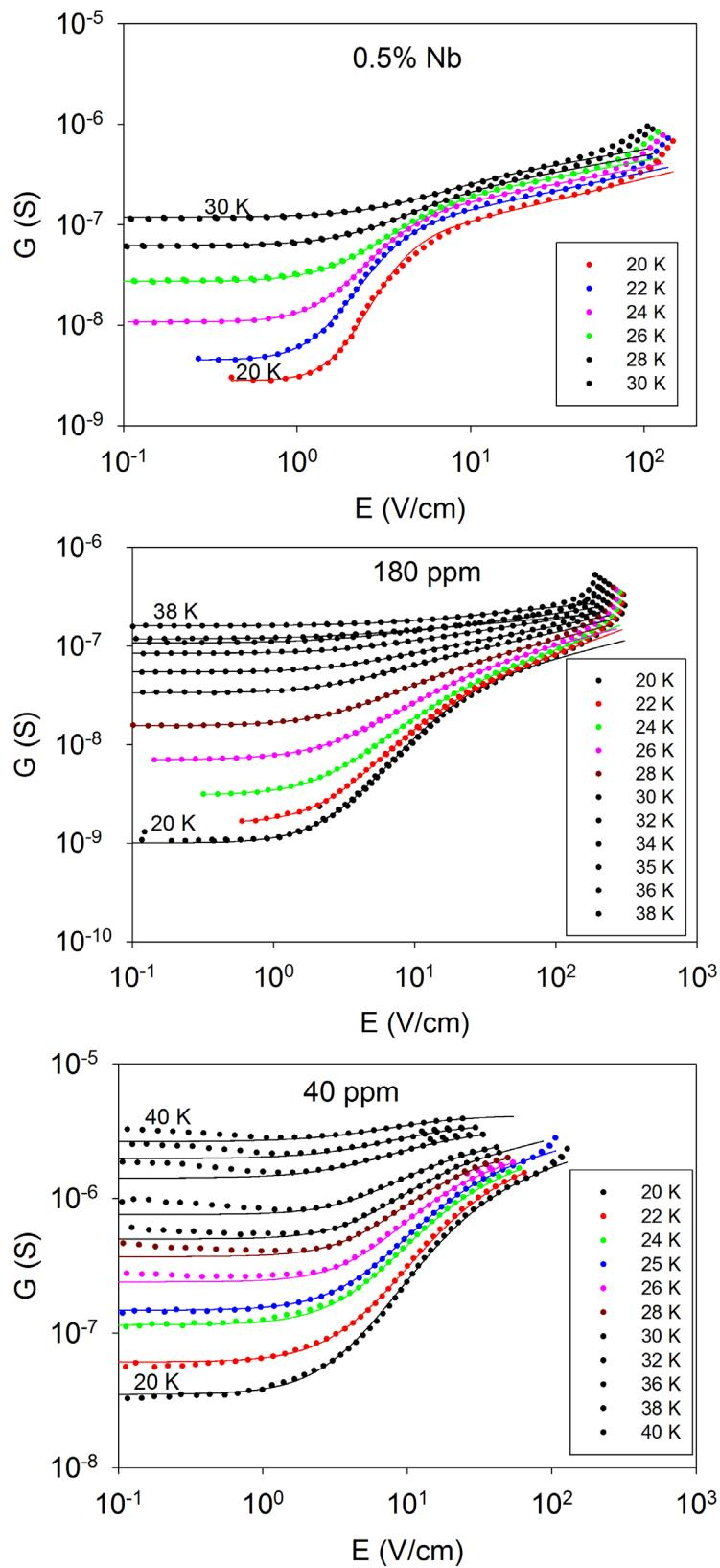
Slika 72 prilagodba niskotemperaturne nelinearnosti triju uzoraka na izraz (152). Prilagodbe su predstavljene punim linijama, a originalni podaci kružićima.
