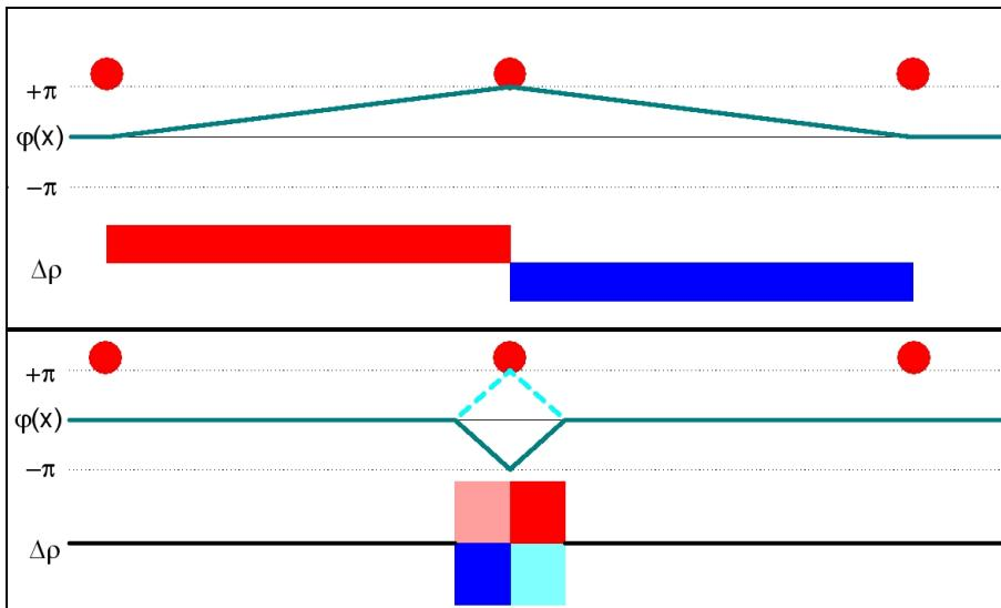
Slika 94 shema polarizacije i varijacije faze preko cijele duljine domene u  $\alpha$  procesu (gore), te preko malog dijela domene u  $\beta$  procesu (dolje). Na grafovima su prikazani promjena faze,  $\varphi(x)$ , i gustoća naboja,  $\Delta\rho(x)$ , između nečistoća.
