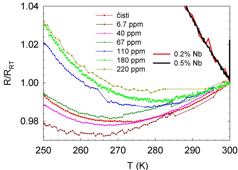
Slika 57 ponašanje minimuma u otporu prije prijelaza sa nivoem i vrstom defekata.
