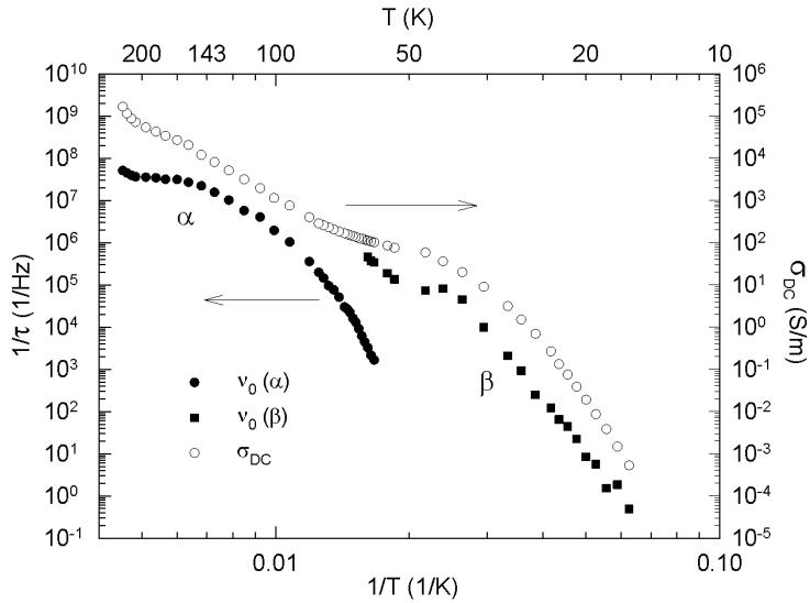
Slika 95 određenost dinamike faze brojem slobodnih nosilaca naboja u čistom uzorku vidljiva je usporedbom relaksacijskih vremena i DC vodljivosti<sup>1</sup>.
