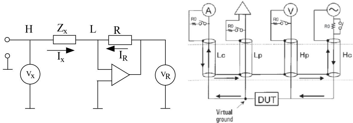
Slika 55 lijevo: metoda mjerena impedancije uzorka autoravnotežnim mostom, desno: dodatni otpor  $R_0$  postavljen je paralelno svakom terminalu za sprečavanje nastanka stojnih valova.
