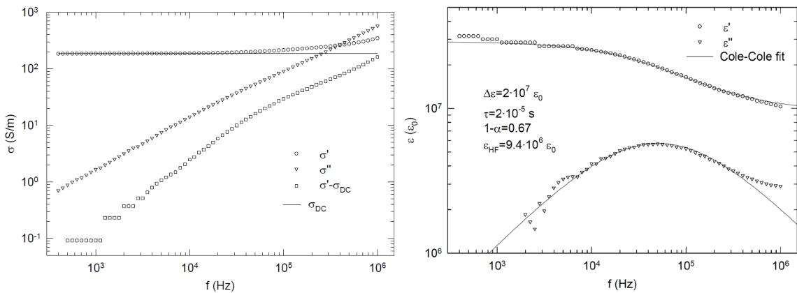
Slika 82 lijevo: ukupni realni i imaginarni dio električne vodljivosti ( $\sigma'$  i  $\sigma''$ ). Od realnog dijela mora se oduzeti jednočestična ( $\sigma_{DC}$ ) vodljivost kako bi se dobila VGN komponenta. Desno: izračunata VGN komponenta dielektričnog odziva (prazni simboli) i prilagodba na kompleksnu funkciju određenom Cole-Cole distribuciju relaksacijskih vremena (odlomak 4.3.5).
