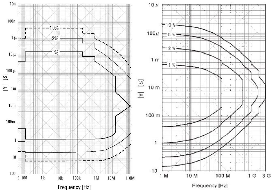
Slika 79 Konture osjetljivosti 1, 3 i 10% instrumenta Agilent 4294 (lijevo) i Agilent 4991 (desno) u  $Y\text{-}f$  prostoru.
