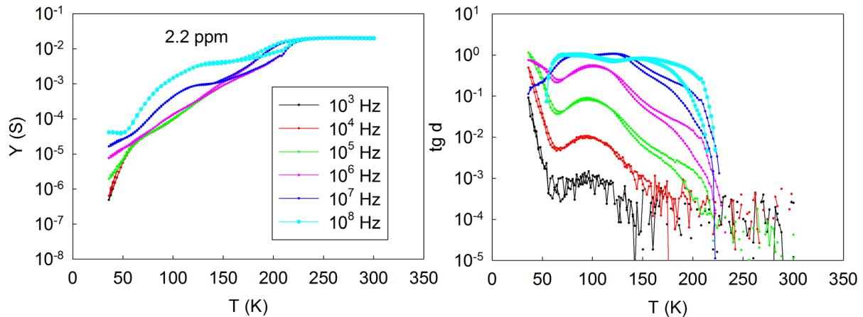
Slika 76 admitancija (lijevo) i omjer imaginarnе i realne vodljivosti uzorka sa 2.2 ppm nivoa ozračenosti izmjerjenih instrumentom Agilent 4294A.
