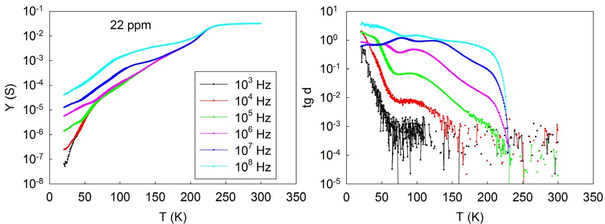
Slika 77 admitancija (lijevo) i omjer imaginarne i realne vodljivosti uzorka sa 22 ppm nivoa ozračenosti izmjerjenih instrumentom Agilent 4294A.
