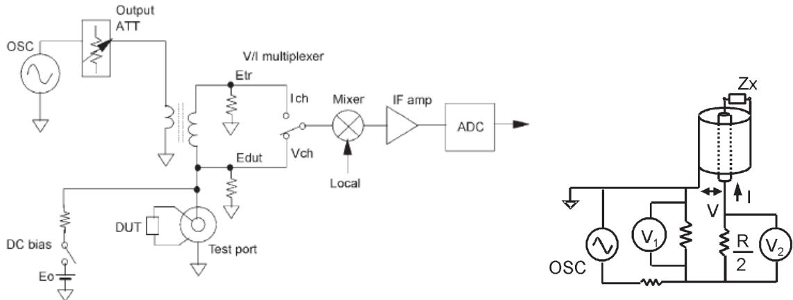
Slika 56 lijevo: shema principa mjerjenja impedancije uzorka (DUT) RF I-V metodom za male vrijednosti impedancije, desno: pojednostavljena shema spoja za visoke vrijednosti impedancije uzorka.
