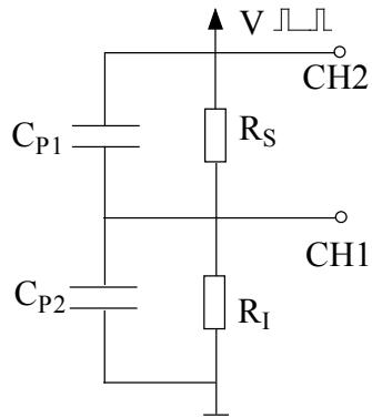
Slika 53 shema za spoj sa naponskim izvorom i parazitskim kapacitetima na uzorku i sa uzorku ( $R_s$ ) prema masi, paralelno sa predotporom koji služi za određivanje struje kroz krug. Radi jednostavnosti su zanemareni efekti kolosalnog dielektričnog odziva. Napon na predotporniku se mjeri na kanalu 1 osciloskopa, dok se napon na uzorku određuje oduzimanjem napona na kanalu 1 i 2 osciloskopa. Ova metoda je korištena za visoka polja i kratka vremena pulseva.
