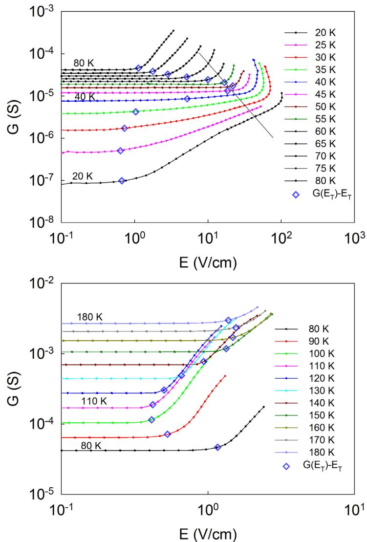
Slika 62 Gore: nelinearni otpor čistog  $\text{TaS}_3$  uzorka između 20 i 80 K, te 80 i 180 K (dolje). Ravna crna linija na gornjoj slici označava liniju konstantne snage grijanja ( $R \sim V^2$ ). Šuplji simboli označavaju  $G(E_T, T)$  ovisnost.
