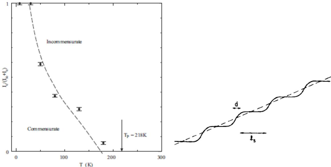
Slika 92 Lijevo: prijelaz iz nesumjerljivog u sumjerljivi VGN iz XRD mjerjenja prikazan preko udjela intenziteta sumjerljive linije. Desno: izmjenjivanje područja sumjerljivosti i nesumjerljivosti u obliku solitonskih dislokacija faze udaljenih za  $l_s$ .
