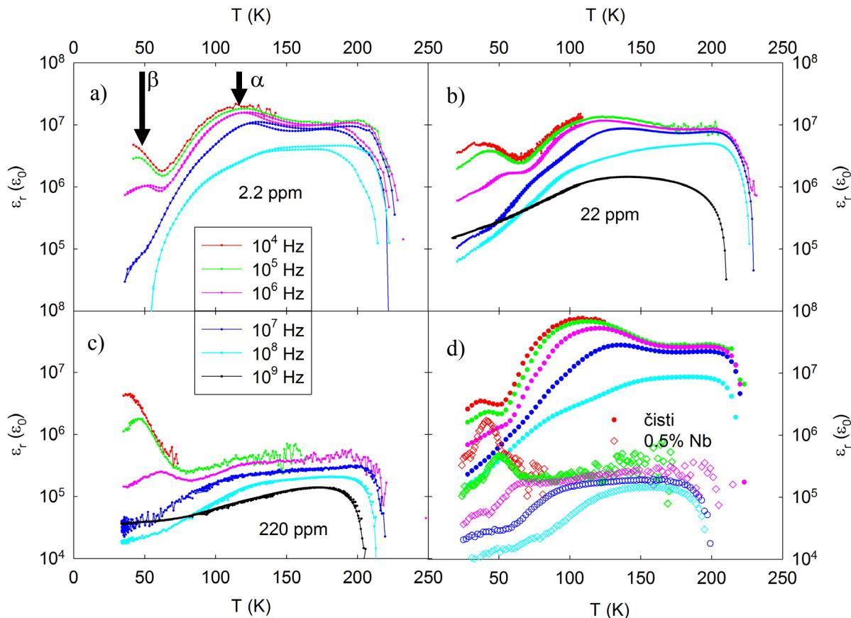
Slika 84 temperaturna evolucija dielektričnog odziva tri ozračena uzorka, jednog dopiranog i čistog na frekvencijama od 10 kHz-1GHz. Ista legenda boja vrijedi za sva 4 panela. U d panelu rezultati na čistom uzorku su prikazani punim, a na dopiranom praznim simbolima. Na a) panelu su označena dva maksimumi odziva na niskim frekvencijama, koji odgovaraju maksimumima amplituda  $\alpha$  i  $\beta$  procesa.
