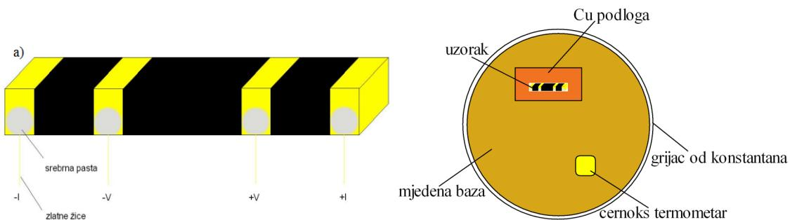
Slika 48 lijevo: način postavljanja kontakata za mjerjenje nelinearnog transporta, desno: razmještaj elemenata na mjedenoj bazi.
