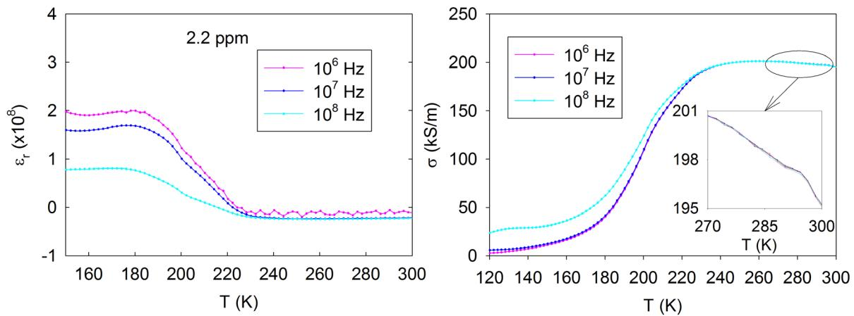
Slika 83 lijevo: realni dio dielektričnog odziva oko temperature prijelaza, desno: vodljivost oko temperature prijelaza. Dio krivulja blizu sobne temperature je povećan u umetku. Za sve frekvencije ispod 10 MHz, a u umetku desne i ispod 100 MHz,  $\sigma(T)$  krivulje se preklapaju (mjereno je do 1 kHz).
