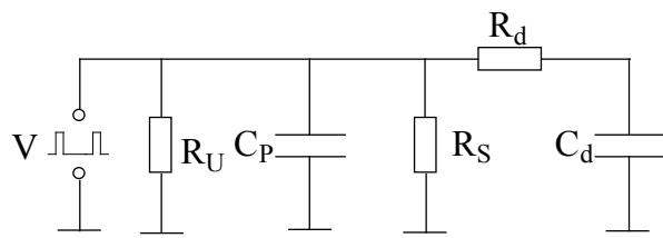
Slika 52 nadomjesna shema VGN uzorka sa velikim dielektričnim odzivom u spoju sa naponskim izvorom.
