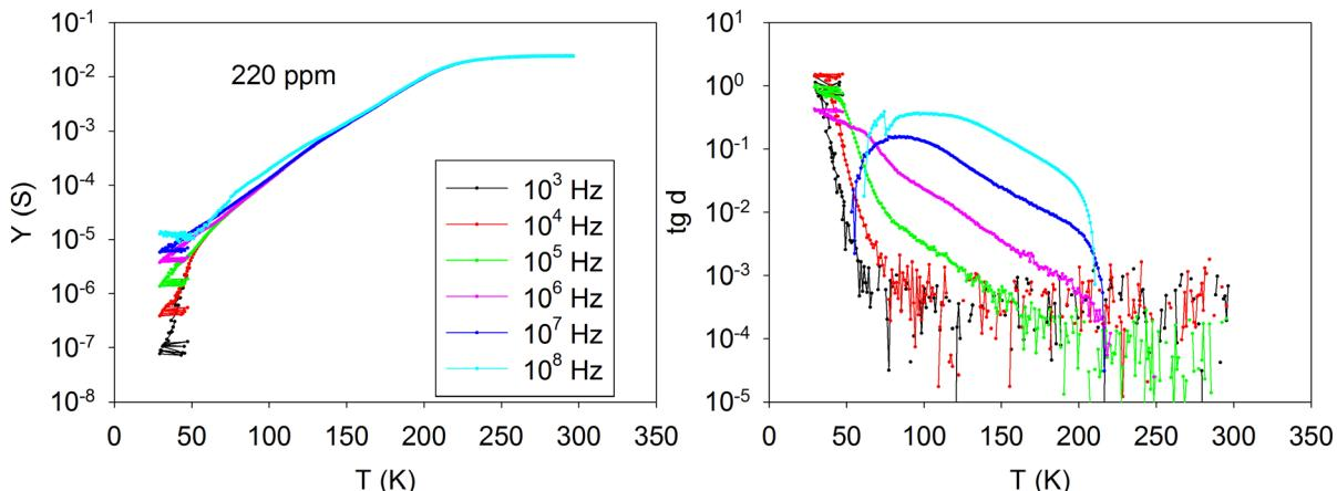
Slika 78 admitancija (lijevo) i omjer imaginarne i realne vodljivosti uzorka sa 220 ppm nivoa ozračenosti izmjerjenih instrumentom Agilent 4294A.
