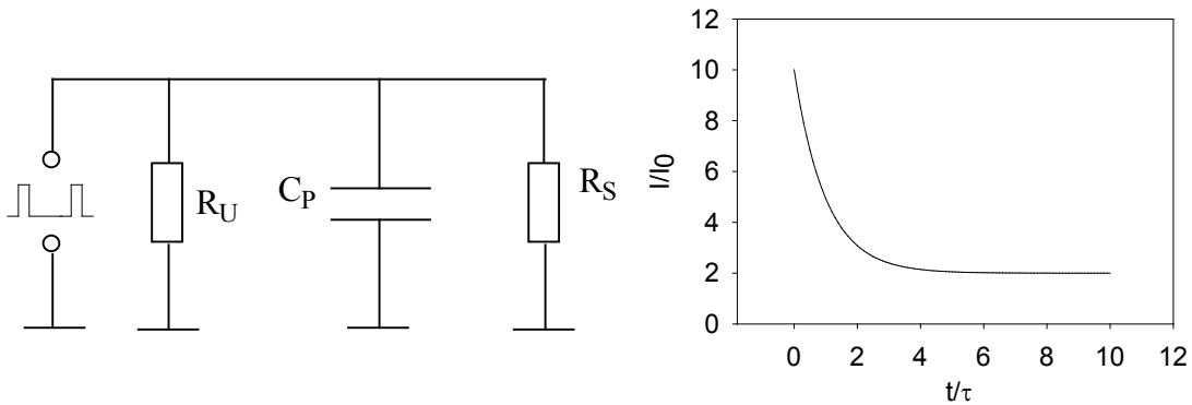
Slika 51 nadomjesna shema (lijevo) i odziv struje (desno) u slučaju postavljanju naponskog izvora pulseva. Naponski izvor je prikazan pomoću strujnog izvora radi analogije.
