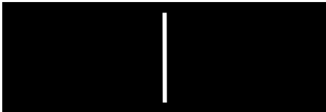
slika na zastoru bez optičke rešetke
