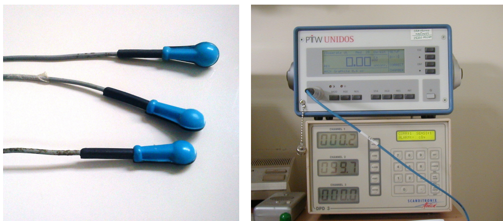
Slika 4-2. a) Dioda, Scanditronix EDE-5. b) Elektrometri: Unidose (PTW) za ionizacijsku komoru, gore i DPD3 (Scanditronix) za diode, dolje.
