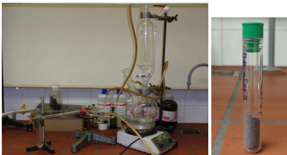
(a) eksperimentalni postav za sintezu magnetskih čestica (b) sintetizirane magnetske nanočestice
