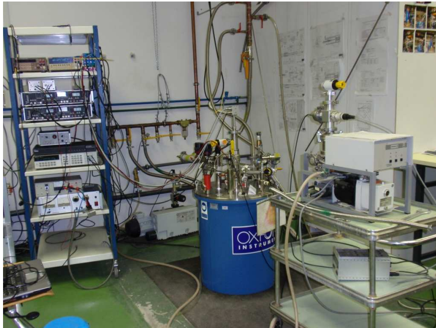
Slika 5.4: Eksperimentalni postav za mjerenje magnetootpora i kritičnih struja \text{MgB}_2 supravodiča.
