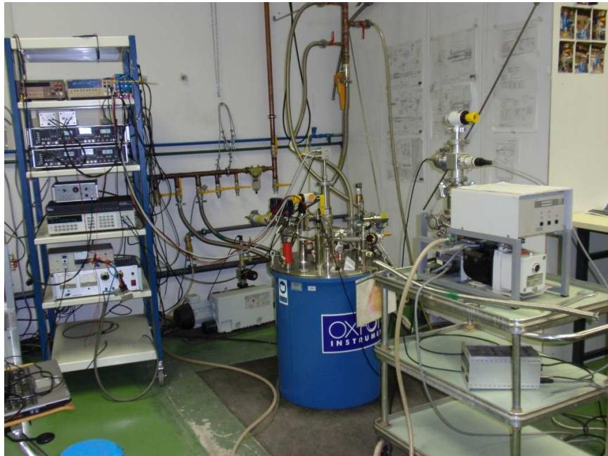
**Slika 5.4:** Eksperimentalni postav za mjerjenje magnetootpora i kritičnih struja  $MgB_2$  supravodiča.
