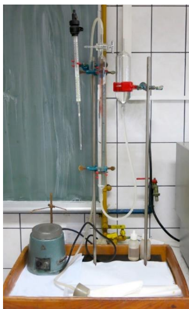
Slika 11: Scheiblerova aparatura za kalcimetriju, Mineraloško-petrografski zavod PMF-a.
