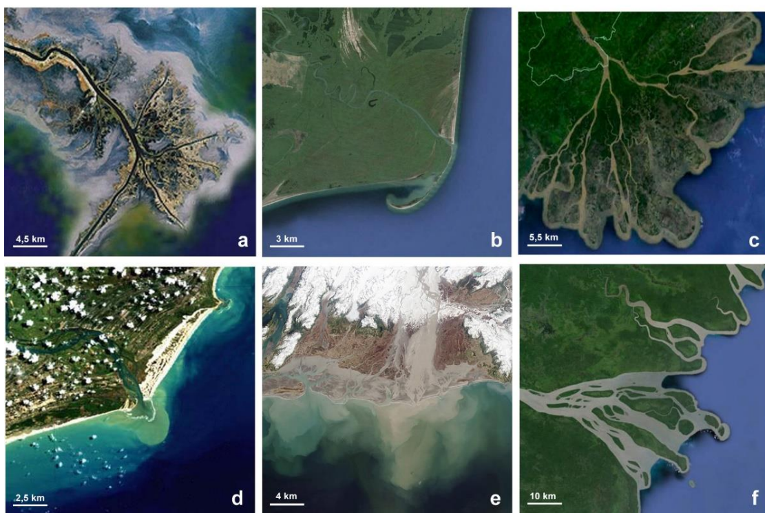
Slika 3: Tipovi riječnih delti: a) delta pod dominantnim utjecajem rijeke (Mississippi), b) delta pod utjecajem rijeke i valova - prijelazni tip (Dunav), c) delta pod utjecajem rijeke i struja morskih mijena - prijelazni tip (Mahakam), d) delta pod utjecajem valova (Sao Francisco), e) delta pod utjecajem valova i struja morskih mijena - prijelazni tip (Copper), f) delta pod utjecajem struja morskih mijena (Fly).
