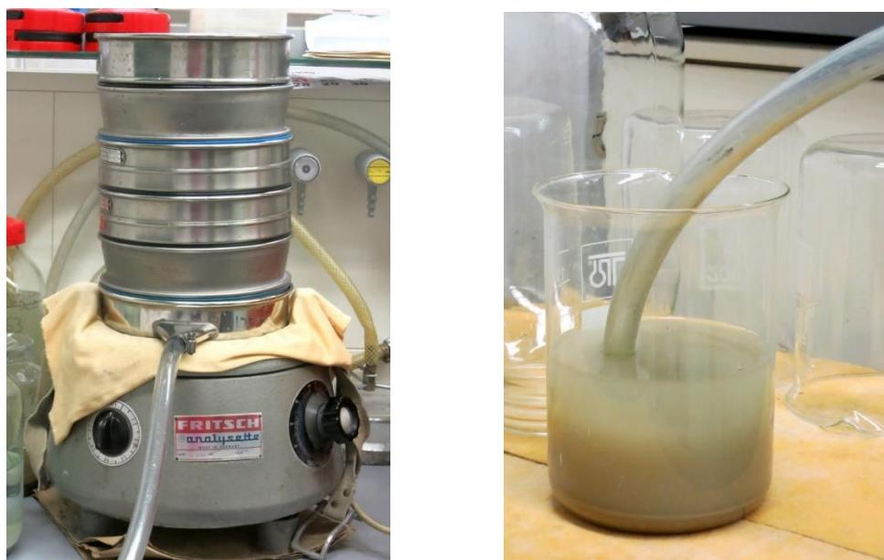
**Slika 9:** Set Retsch® ASTM sita, Geološko-paleontološki zavod PMF-a.
