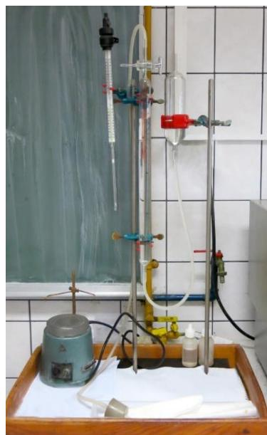
**Slika 11:** Scheiblerova aparatura za kalcimetriju, Mineraloško-petrografski zavod PMF-a.
