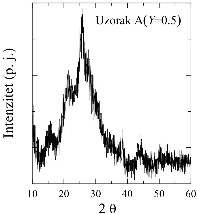
Slika 6.1: Difraktogram uzorka PANI-HCl dobivenog izravno iz sinteze (uzorak A,  $Y=0.5$ ). Na difraktogramu je vidljiv centralni široki signal koji je posljedica amorfnosti te široki Braggovi maksimumi koji su superponirani na amorfni signal. Pojava Braggovih maksimuma sugerira uređivanje polimernih lanaca.
