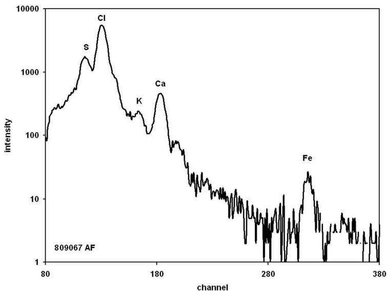
Slika 5.3: *PIXE spektar uzorka B ( $Y=0.0$ , dedopirani uzorak).* Spektar prikazuje prisutnost nečistoće u obliku atoma sumpora, klora, kalija, kalcija i željeza u koncentracijama koje se mjeru u ppm.
