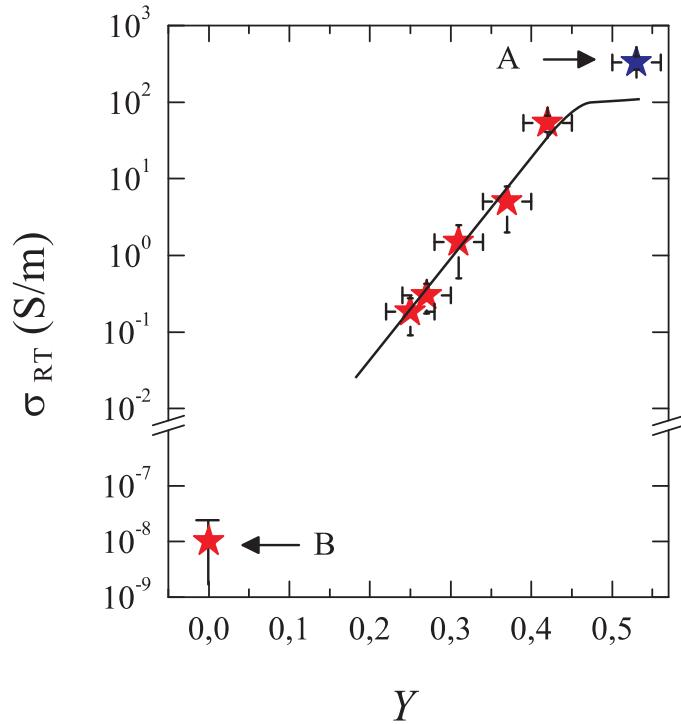
Slika 6.5: Eksperimentalno utvrđena ovisnost  $\sigma_{RT}$  o stupnju dopiranja  $Y$ . Simboli  $\star$  i  $\blacktriangleleft$  predstavljaju uzorke podvrgnute elementnoj analizi.  $\star$  označava uzorak A ( $Y=0.5$ ), a  $\star$  uzorke dobivene procesom kontroliranog dopiranja. Puna linija predstavlja konstruiranu krivulju dopiranja (za njezin opis vidjeti tekst).
