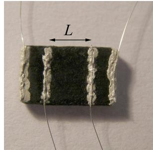
Slika 5.1: *Slika uzorka PANI-HCl s strujnim i naponskim kontaktima izrađenim pomoću srebrne paste. Oznaka L označava udaljenost između naponskih kontakata. Dimenzija uzorka je  $8 \times 5 \times 1 \text{ mm}^3$ .*
