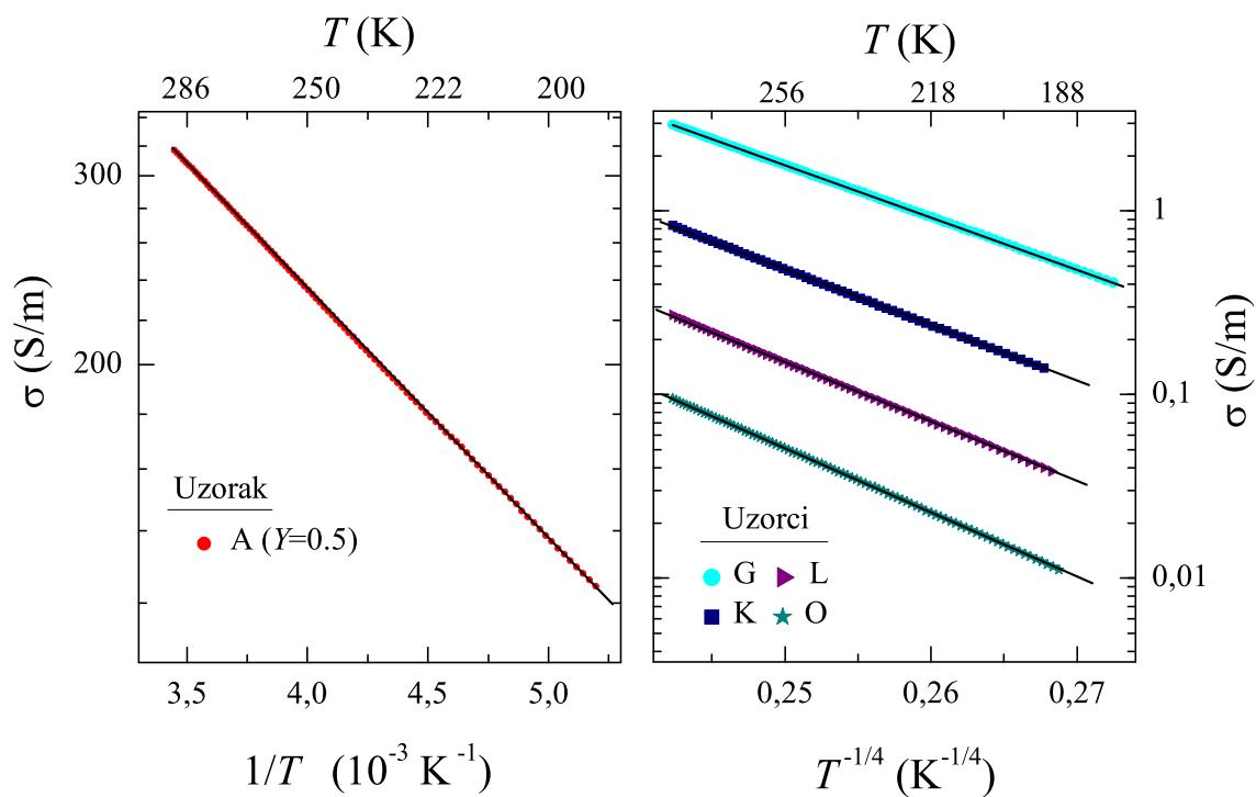
Slika 6.18: Kako bi se provjerile vrijednosti  $\alpha$  dobivene logaritamskom derivacijom provodnosti, uzorak A (slika desno) je prikazan u ovisnosti  $\ln \sigma(T)$  o  $1/T$ , a uzorci G, K, L i O (slika lijevo) u ovisnosti  $\ln \sigma(T)$  o  $T^{-1/4}$ . U oba slučaja podaci pokazuju linearost. Pune linije povućene su kao vodilja oku u praćenju linearnosti.
