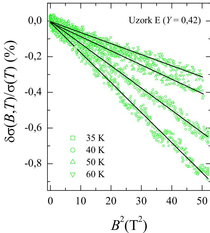
Slika 6.20: Ovisnosti MP  $\delta\sigma(T, B)/\sigma(T)$  o kvadratu magnetskog polja za uzorak E ( $Y=0.42$ ). Mjerenje je izvršeno na 35 K, 40 K, 50 K i 60 K. MP pokazuje linearnost u prikazanom skaliranju osi. Pravci su dobiveni linearnom prilagodbom na eksperimentalne podatke. MP je izrazito slaba, < 1% na 7 T i 35 K.
