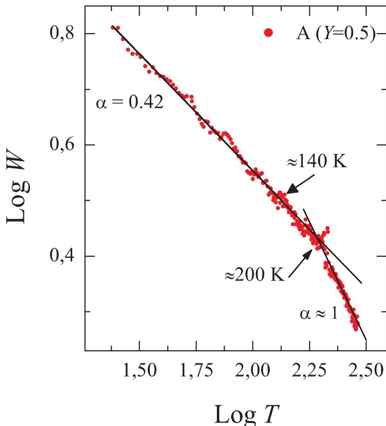
Slika 6.14: Ovisnost  $\log W$  o  $\log T$  za uzorak A ( $Y = 0.5$ ). Na niskim temperaturama ovisnost je linearna s vrijednošću parametra  $\alpha = (0.42 \pm 0.02)$ , dok je na višim temperaturama  $\alpha \approx 1$ . Oznaka  $\approx 140$  K predstavlja temperaturu do koje je postignuta linearost na slici 6.11(desno). Pune linije dobivene su linearnom prilagodbom na podatke analize. Temperatura je izražena u K.
