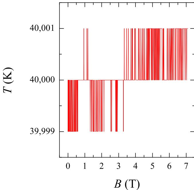
Slika 5.5: Slika prikazuje stabilnost temperature na  $40 \text{ K}$ . Vidljiva je stabilnost temperature unutar  $\pm 1 \text{ mK}$  za magnetska polja od  $0 \text{ T}$  do  $7 \text{ T}$ .
