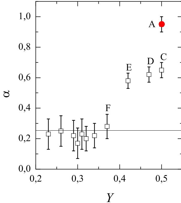
Slika 6.17: Visokotemperaturne ( $T \gtrsim 200\text{ K}$ ) vrijednosti parametra  $\alpha$  određene primjenom metode logaritamske derivacije provodnosti u ovisnosti o  $Y$ . Za uzorak A (puni simbol) parametar  $\alpha$  ima vrijednost oko 1. Za uzorke C ( $Y=0.5$ ) i E ( $Y=0.42$ ) vrijednost se kreće oko 0.6, dok za uzorak F ( $Y=0.38$ ) i slabije dopirane uzorke  $\alpha$  pada na oko 0.25. Horizontalni pravac predstavlja  $\alpha=1/4$ .
