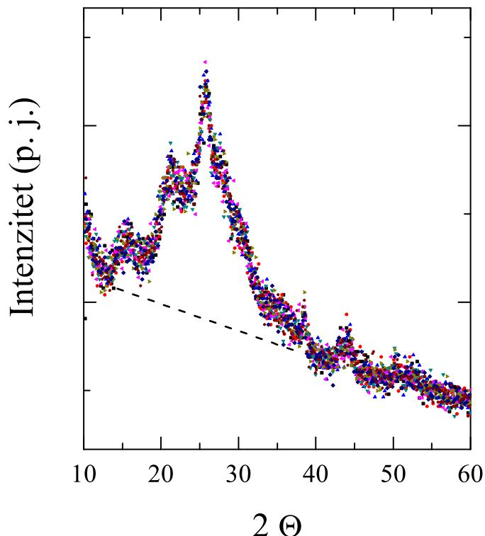
Slika 5.4: *Izgled difraktograma za uzorak A ( $Y=0.5$ , dobiven izravno iz sinteze) bez korekcije pozadinskog signala. Na difraktogramu se jasno vidi pozadinski signal kojeg treba oduzeti prilikom analize. Isprekidana linija pokazuje kako se pozadinski signal može po dijelovima aproksimirati pravcem.*
