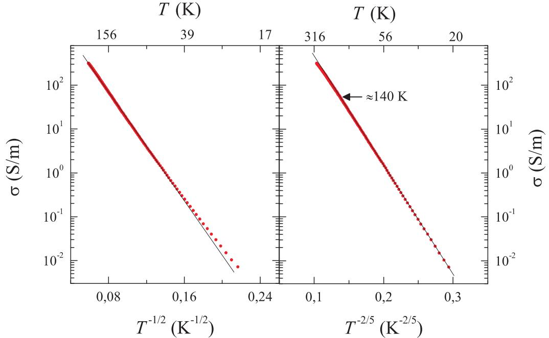
Slika 6.11: *Električna provodnost uzorka A ( $Y=0.5$ ) u ovisnosti  $\log \sigma(T)$  o  $T^{-1/2}$  (lijevo) i  $\log \sigma(T)$  o  $T^{-2/5}$  (desno).* Slika lijevo: provodnost odstupa od linearnosti na niskim temperaturama u prikazanoj skali. Slika desno: provodnost je linearna na niskim temperaturama. Pravci su prikazani da indiciraju linearnost, odnosno odstupanje od linearnosti. Strelica (slika desno) označava temperaturu gdje linearnost prestaje.
