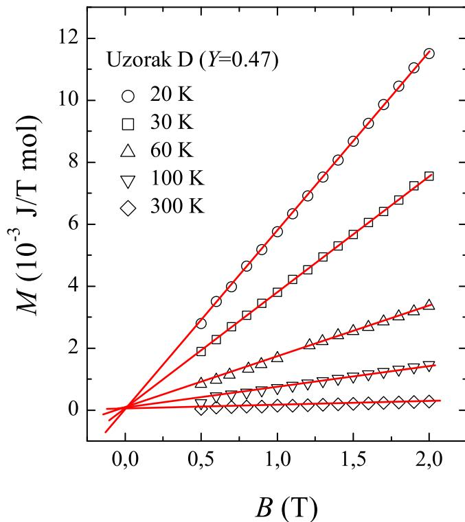
Slika 6.22: Magnetizacija uzorka D ( $Y=0.47$ ) nakon što je korigirana za doprinos magnetizacije spremnika i oduzet doprinos  $M_0^D$ . Magnetizacija uzorka pokazuje paramagnetsko ponašanje za sve mjerene temperature. Vidljivo je da su magnetizacije linearne za sve temperature u području od 0.5 T do 2 T. Podaci za polja  $< 0.5$  T su izostavljeni. Pune linije dobivene su linearnom prilagodbom na eksperimentalne podatke.
