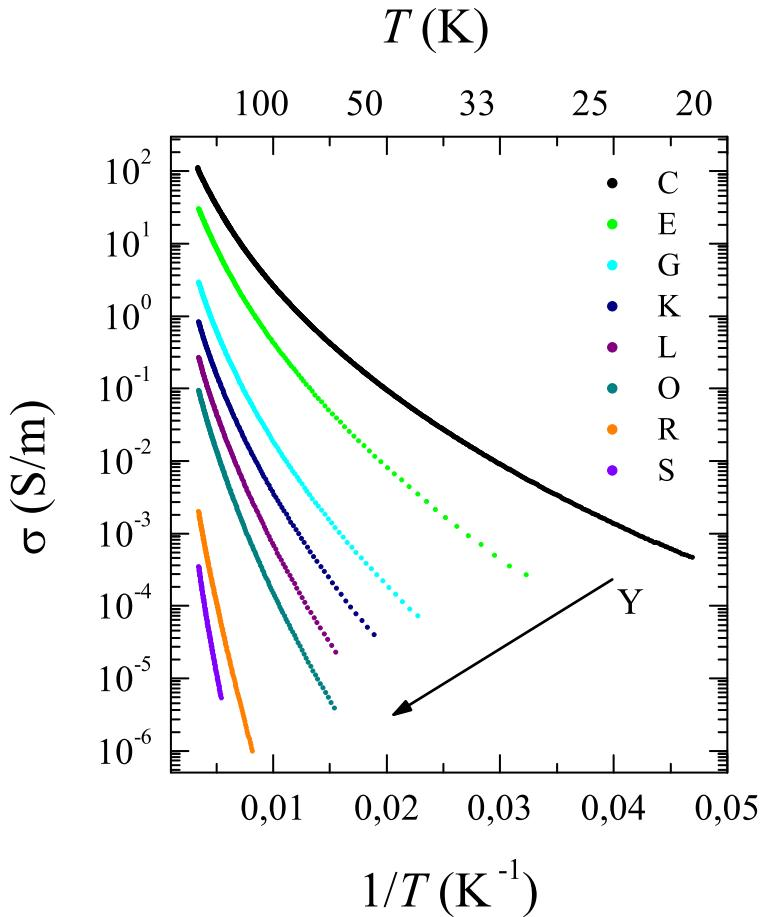
Slika 6.9: Električna provodnost uzorka koji su prošli proces dedopiranja te ponovnog kontroliranog dopiranja (zbog preglednosti prikazani su samo odbarani uzorci). Provodnost je prikazana u ovisnosti  $\log \sigma(T)$  o  $T^{-1}$ . Ni jedan od prikazanih uzorka ne pokazuje linearost u cijelom temperaturnom području. Strelica označava smjer smanjivanja parametra  $Y$ . Provodnost je prikazana od sobne temperature.
