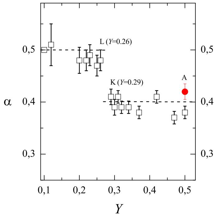
Slika 6.16: Vrijednosti parametra  $\alpha$  dobivenih korištenjem logaritamske derivacije provodnosti ( $W$ ) za sve uzorke. Ispunjениm krugom označen je uzorak A ( $Y=0.5$ ). Nepouzdanosti su prikazane kao tri standardne devijacije. I uz tako precijenjene vrijednosti nepouzdanosti nema prekrivanja između  $\alpha = 0.4$  i  $0.5$ . Do prijelaza u  $\alpha$  dolazi između uzorka K ( $Y=0.29$ ) i uzorka L ( $Y=0.26$ .)
