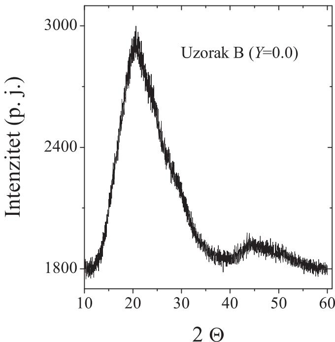
Slika 6.2: Difraktogram nedopiranog uzorka (uzorak B,  $Y=0.0$ ). Difraktogram se sastoji od dva nesimetrična vrlo široka maksimuma, što upućuje da ne postoji dugodosežno uređenje, odnosno da je uzorak B u potpunosti amorfan.
