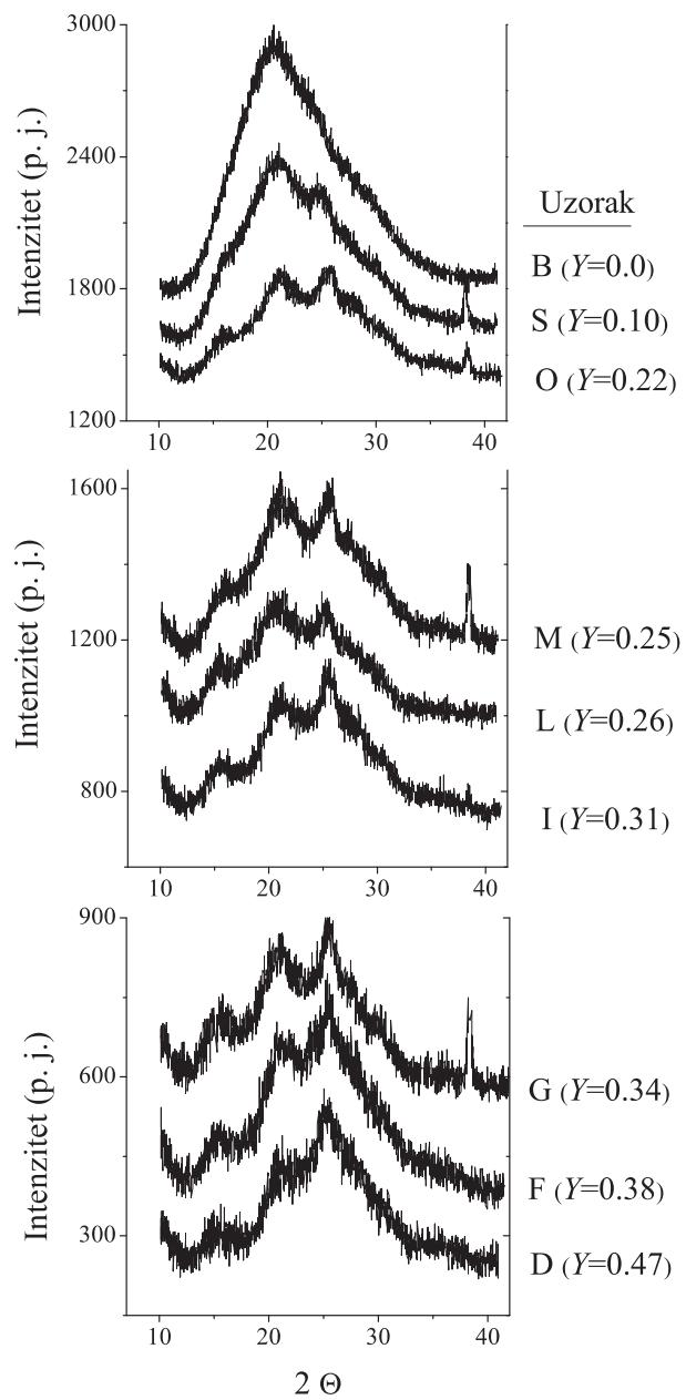
Slika 6.3: Difraktogrami uzoraka PANI-HCl različitih stupnjeva dopiranja. Pomoću difraktograma se može pratiti evolucija rasta Braggovih maksimuma i smanjenja amorfognog signala povećanjem stupnja dopiranja,  $Y$ . Braggov maksimum koji se pojavljuje na oko  $2\Theta=40^\circ$  dolazi od srebrne paste koja je korištena za izradu kontakata kod transportnih mjerena.
