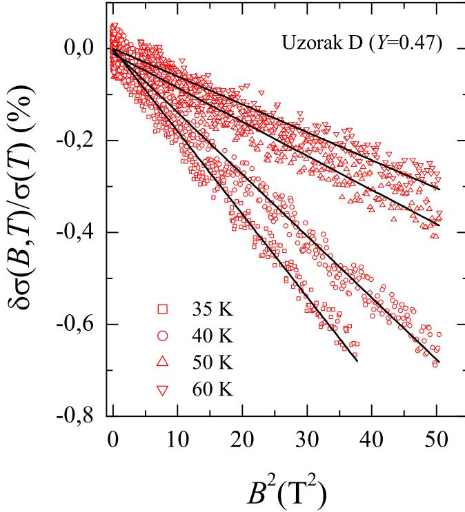
Slika 6.19: *Ovisnosti MP  $\delta\sigma(T, B)/\sigma(T)$  o kvadratu magnetskog polja za uzorak D ( $Y=0.47$ ). Mjerenje je izvršeno na 35 K, 40 K, 50 K i 60 K. MP pokazuju linearost u prikazanom skaliranju osi. Pravci su dobiveni linearom prilagodbom na eksperimentalne podatke. MP je izrazito slaba, < 1% na 6 T i 35 K.*
