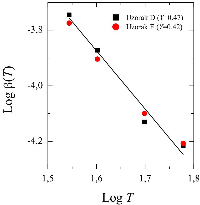
Slika 7.4: Ovisnost parametra  $\log \beta(T)$  o  $\log T$  za uzorke D i E. Pravac je dobiven linearnom regresijom, pri čemu mu je vrijednost nagiba  $-(2.0 \pm 0.3)$ .  $\beta(T)$  je izražen u  $T^{-2}$ , dok je  $T$  u K.
