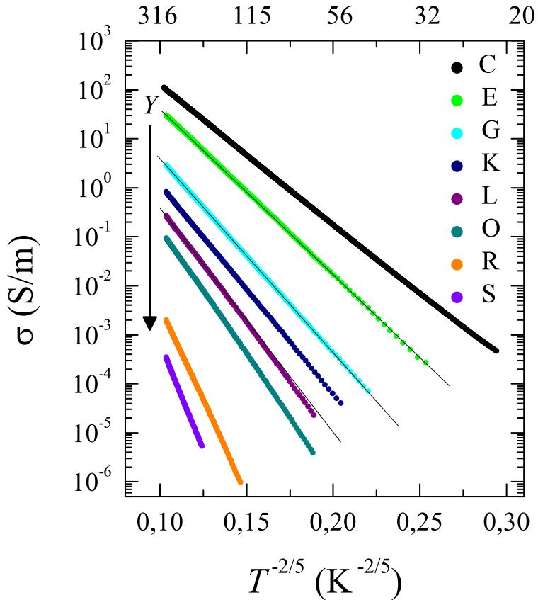
Slika 6.13: *Ovisnost log  $\sigma(T)$  o  $T^{-2/5}$  uzoraka različitog stupnja dopiranja  $Y$ . Uzorci C, E, G, K i uzorci koji se nalaze između njih pokazuju linearost, dok ostali uzorci pokazuju odstupanje od linearnosti. Pravci su prikazani da indiciraju linearost, odnosno odstupanje od linearnosti ovisno o vrsti uzorka. Strelica označava smjer smanjivanja parametra  $Y$ . Provodnost je prikazana od sobne temperature.*
