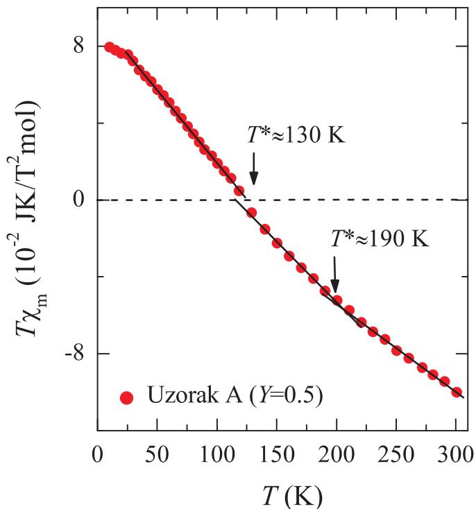
Slika 6.26: Slika ovisnosti  $T\chi_m$  o  $T$  za uzorak A ( $Y=0.5$ ) u temperaturnom području od 10 K do 300 K i magnetskom polju od 2 T.  $\chi_m(T)$  je podijeljena na tri područja koja pokazuju linearost u danoj skali (označeno s  $T^*$ ). Vrijednosti parametara koji opisuju pravce dati su u tablici 6.4. Područja u susceptibilnosti podudaraju se s područjima koja su određena u transportnim mjerjenjima. Isprekidana linija odvaja dijamagnetsko od paramagnetskog područja.
