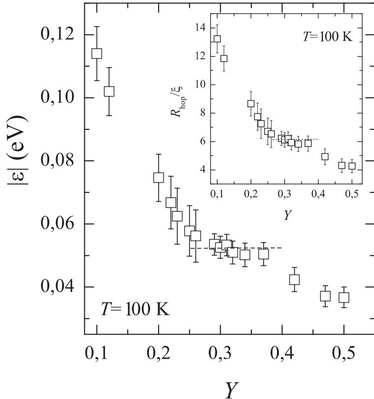
Slika 7.3: Ovisnost parametra  $\epsilon$  o  $Y$  na 100 K. Parametar se kontinuirano povećava smanjenjem  $Y$ . Umetak: Ovisnost parametra  $R_{\text{hop}}/\xi$  o  $Y$  na 100 K. Na obje slike isprekidana linja simbolizira područje u kojem se  $T_{0,\alpha}$  ne mijenja.
