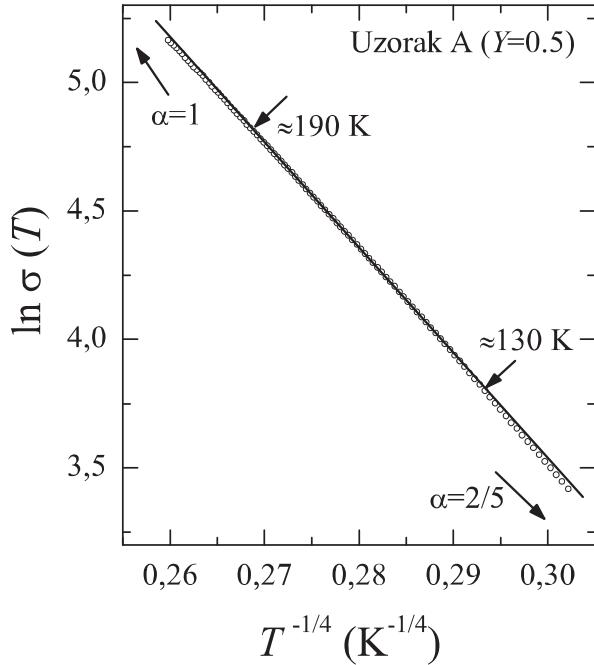
Slika 7.1: Ovisnost  $\ln \sigma(T)$  o  $T^{-1/4}$  za uzorak A ( $Y=0.5$ ). Uzorak pokazuje zadovoljavajuću linearnost, iako je temperaturno područje u kojem se gleda provodnost mala. S lijeve i desne strane promatranog intervala dolazi do devijacije od pravca koji je dobiven linearnom prilagodbom na podatke unutar temperaturnog intervala (140-190 K). Veličina ispod prirodnog logaritma je izražena u  $\text{S}/\text{m}$ .
