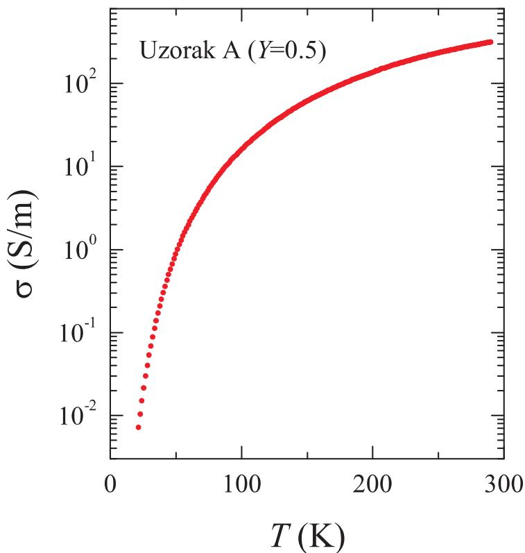
Slika 6.6: Temperaturna ovisnost električne provodnosti za uzorak A ( $Y=0.5$ ) koji je dobiven izravno iz sinteze. Provodnost je izolatorskog oblika ( $d\sigma/dT > 0$ ) u cijelom mjernom temperaturnom području, odnosno monotono se smanjuje snižavanjem temperature.
