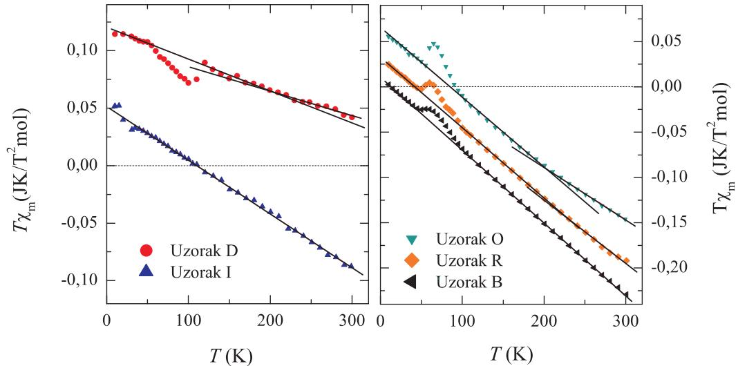
Slika 6.27: Slika ovisnosti  $T\chi_m$  o  $T$ , za uzorake D, I, O, R i B u temperaturnom području od 10 K do 300 K i magnetskom polju od 2 T. Krivulje su odvojene na dvije slike zbog jasnoće prikaza. Pune linije dobivene su linearnom prilagodbom na mjerene podatke. Uzorci D, O i R pokazuju drugačije nagibe na visokim i niskim temperaturama, što je označeno pravcima. Isprekidana linija odvaja dijamagnetsko od paramagnetskog područja.
