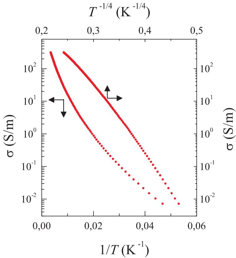
Slika 6.8: Električna provodnost uzorka A ( $Y=0.5$ ) prikazana u ovisnostima  $\log \sigma(T)$  o  $T^{-1}$  (lijevo i dolje) i  $\log \sigma(T)$  o  $T^{-1/4}$  (desno i gore). Vidljivo je da ni u jednoj prikazanoj ovisnosti eksperimentalni podaci ne pokazuju linearost preko cijelog temperaturnog područja.
