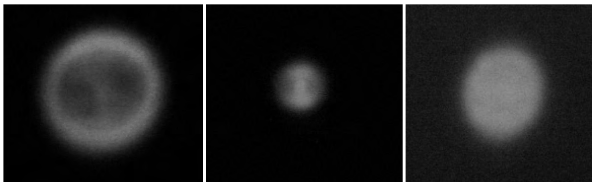
Slika 4.13: Fotografije konusne emisije u gustim parama rubidija. Centralne valne duljine ulaznog laserskog pulsa su redom slijeva na desno: 760, 780 i 820 nm.
